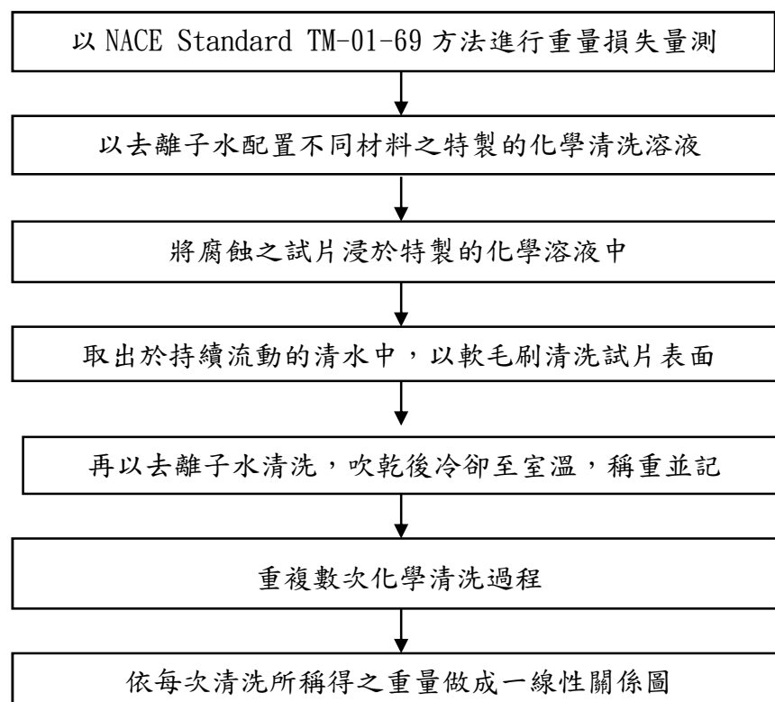
圖 5.15 水下金屬腐蝕生成物清除作業流程圖
