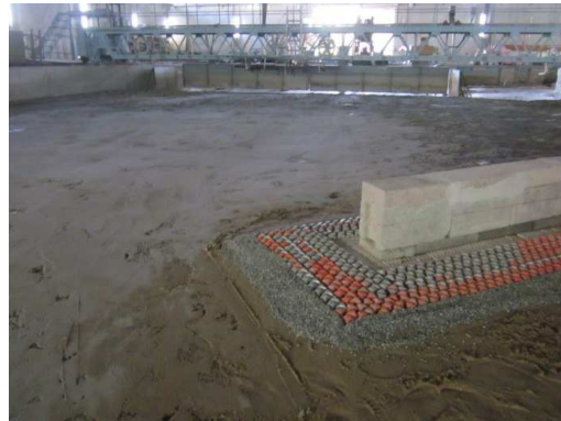
圖 7.22 完成動床地形及堤頭鋪設
