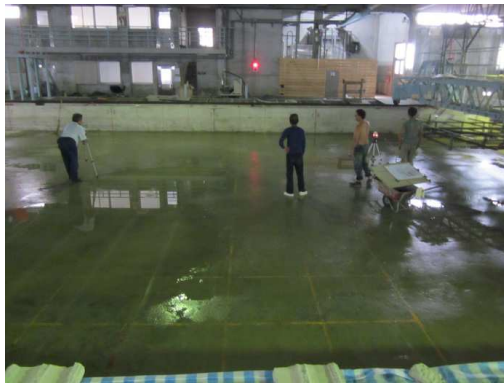
圖 7.22 完成動床地形及堤頭鋪設
