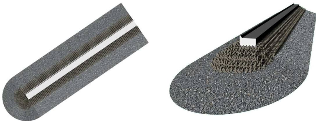
圖 7.39 數值模型防波堤設計圖
