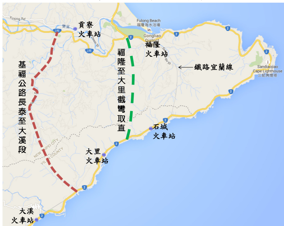
圖 4.1-1 台 2 線福隆至大里段截彎取直示意圖
