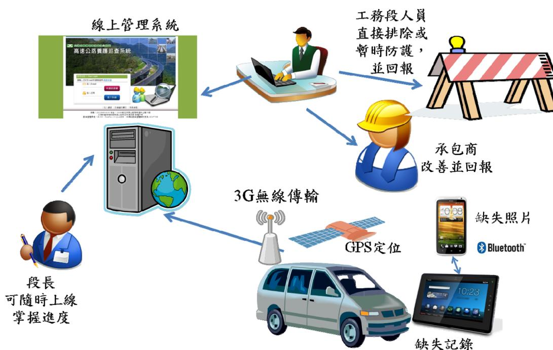
圖 4-31 以平板電腦及智慧型手機進行整合之巡查系統運作架構
