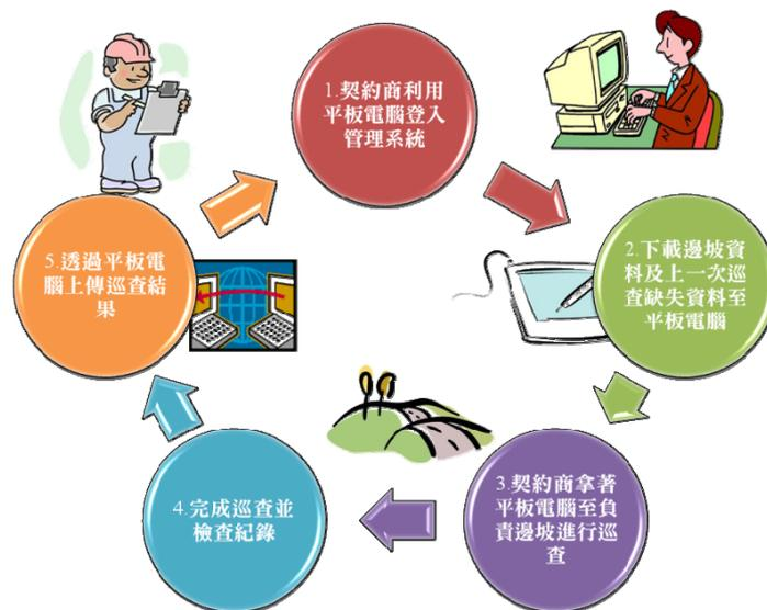
圖 6-2 新規劃之邊坡巡查作業流程
