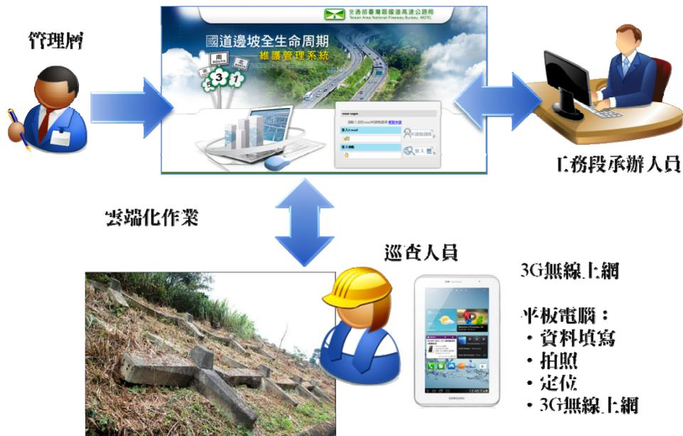
圖 6-3 邊坡巡查雲端化運作架構
