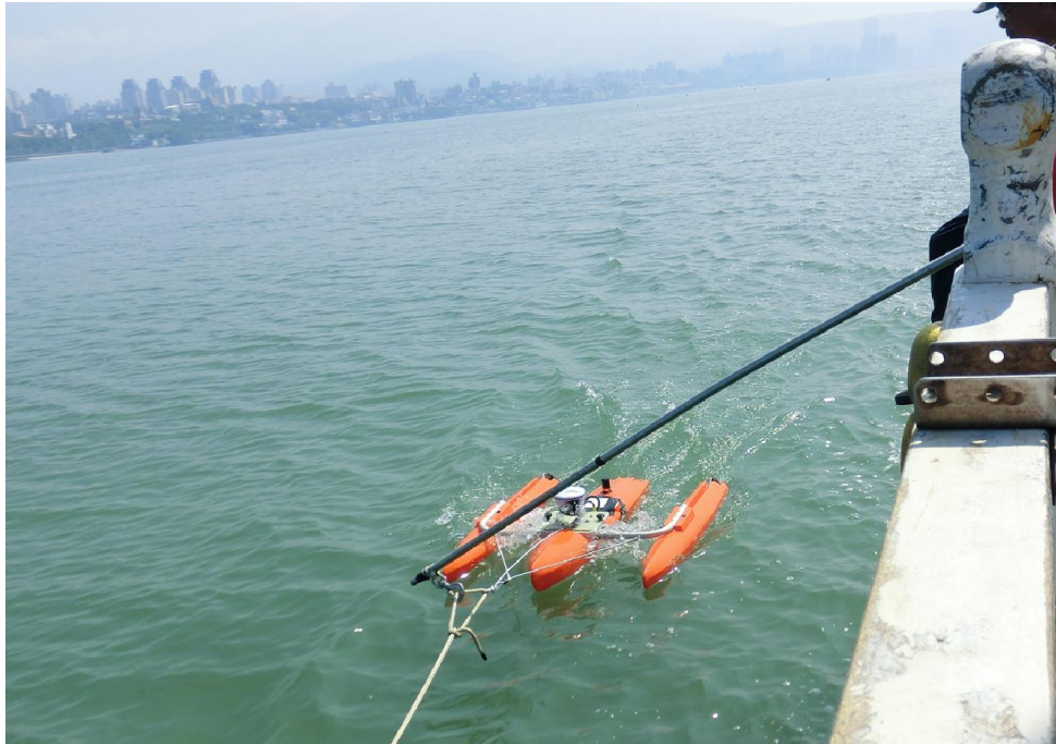
圖 1.3 徑向斷面流場觀測作業
