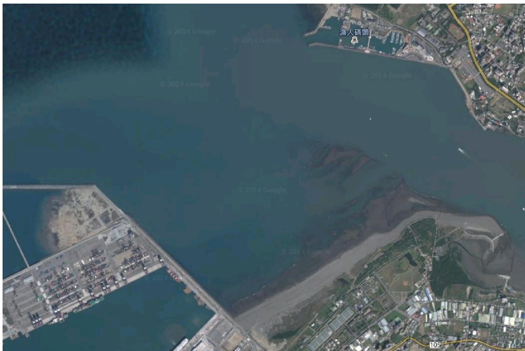
圖 3.66 低潮時臺北港北堤淤砂區之海岸沙洲(Google map)
