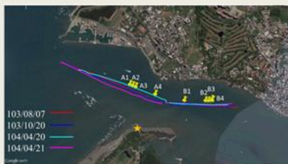
圖 2.17 2014 River-Ray ADCP 在淡水河口進行量測之航路
