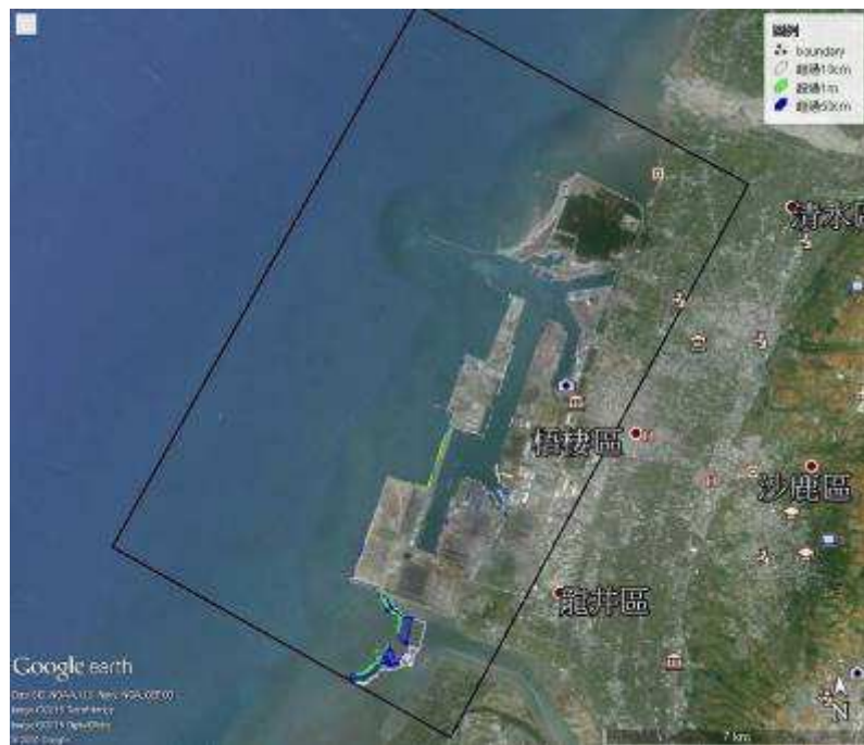
圖 5.29(b) 臺中港結合 Google Earth 之溢淹圖(DSM)，入射波高 1 公尺
