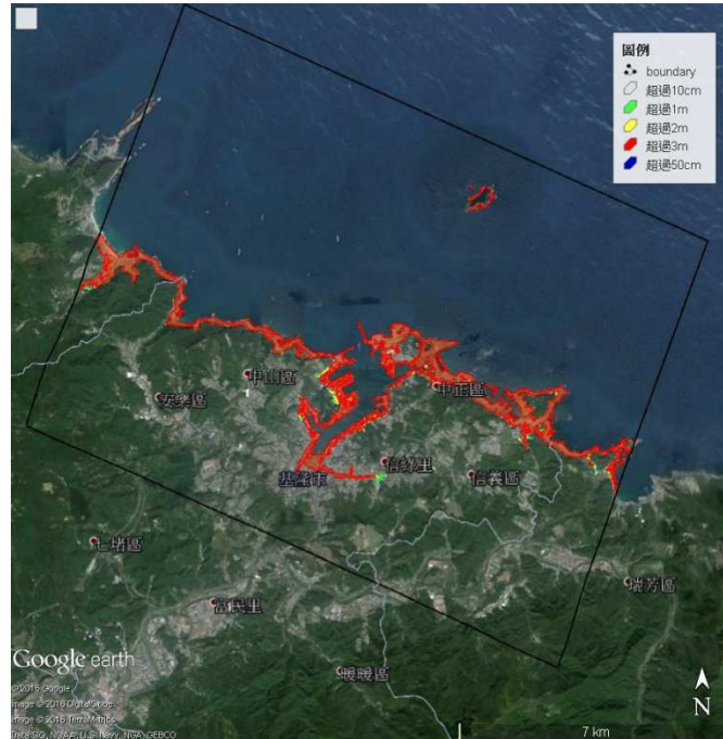
圖 5.34(g) 基隆港結合 Google Earth 之溢淹圖(DSM)，入射波高 10 公尺
