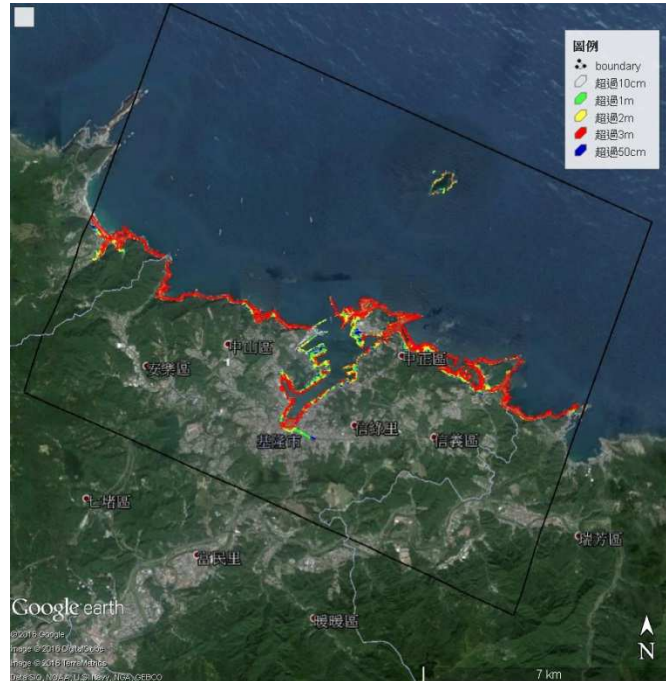
圖 5.34(e) 基隆港結合 Google Earth 之溢淹圖(DSM)，入射波高 4 公尺
