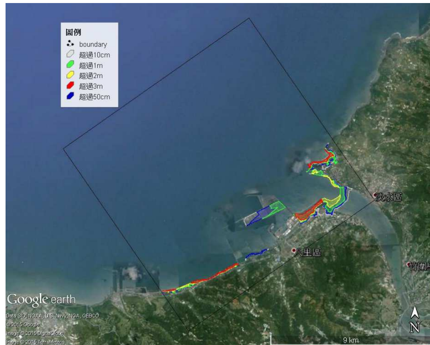
圖 5.41(c) 臺北港結合 Google Earth 之溢淹圖(DEM)，入射波高 2 公尺
