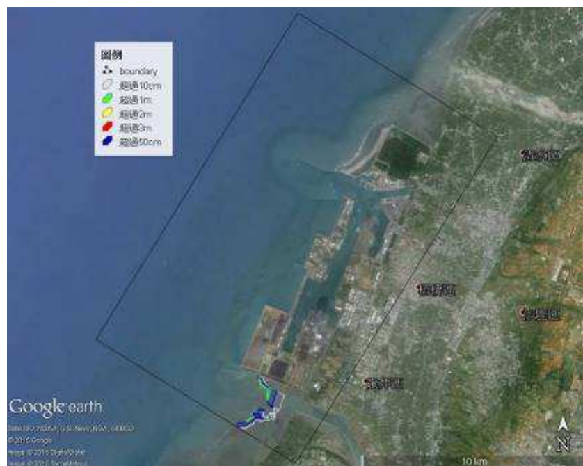
圖 5.37(a) 臺中港結合 Google Earth 之溢淹圖(DEM)，入射波高 0.5 公尺
