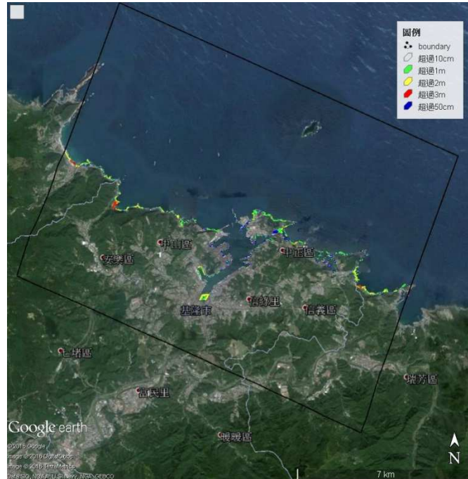
圖 5.34(a) 基隆港結合 Google Earth 之溢淹圖(DSM)，入射波高 0.5 公尺
