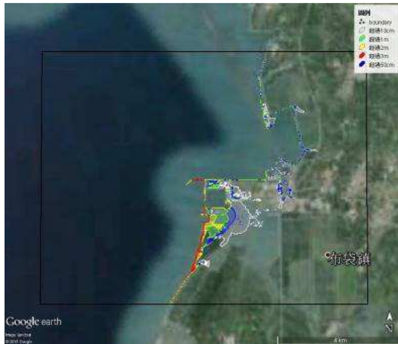
圖 5.30(e) 布袋港結合 Google Earth 之溢淹圖(DSM)，入射波高 4 公尺
