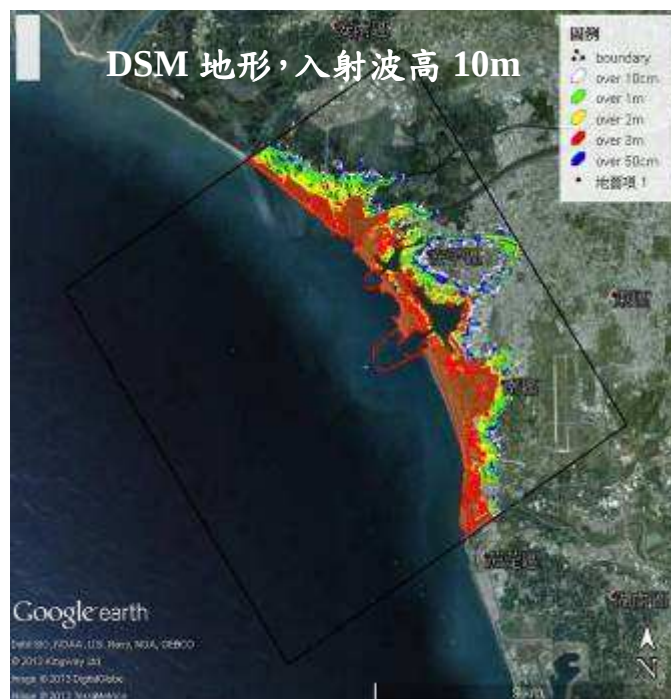
圖 5.31(g) 安平港結合 Google Earth 之溢淹圖(DSM)，入射波高 10 公尺
