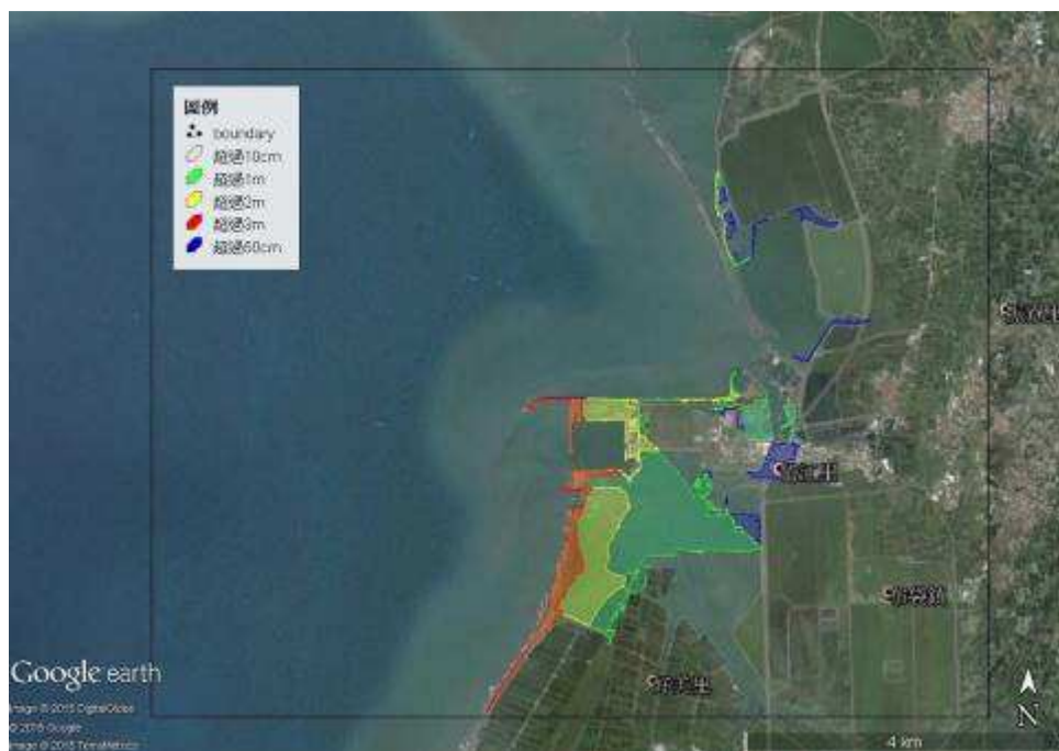
圖 5.38(d) 布袋港結合 Google Earth 之溢淹圖(DEM)，入射波高 3 公尺
