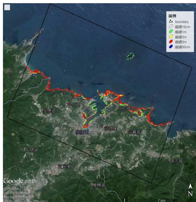
圖 5.34(d) 基隆港結合 Google Earth 之溢淹圖(DSM)，入射波高 3 公尺
