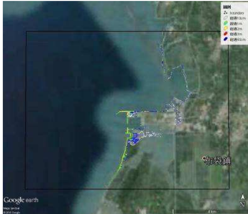
圖 5.30(c) 布袋港結合 Google Earth 之溢淹圖(DSM)，入射波高 2 公尺
