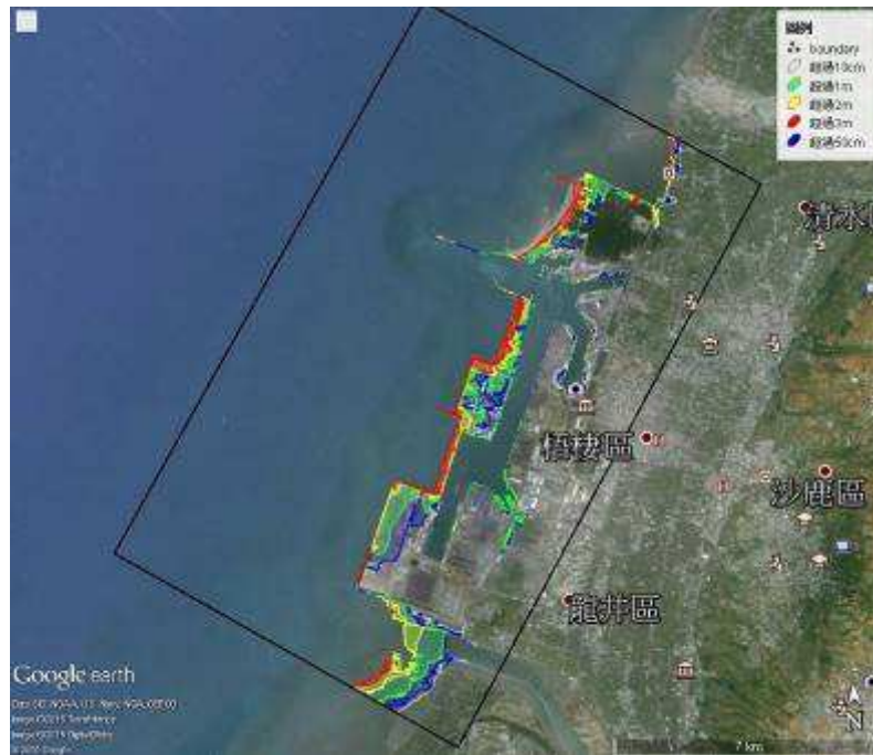
圖 5.29(e) 臺中港結合 Google Earth 之溢淹圖(DSM)，入射波高 4 公尺
