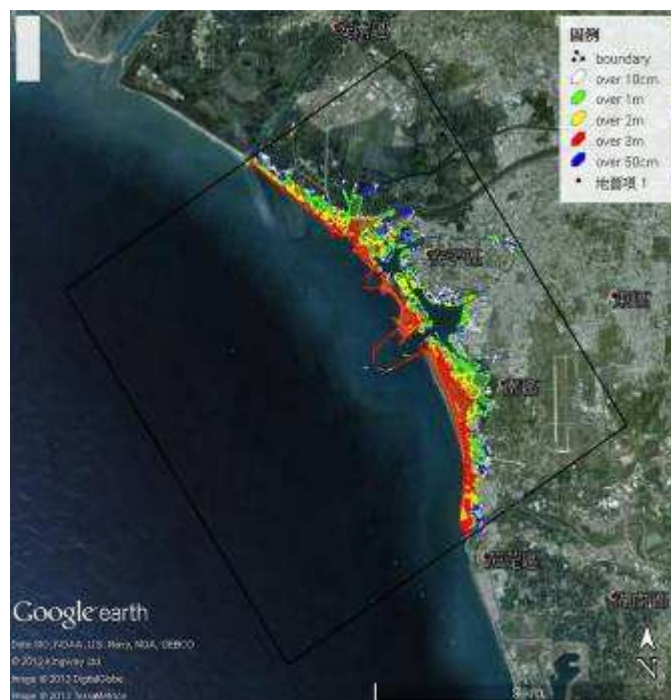
圖 5.31(f) 安平港結合 Google Earth 之溢淹圖(DSM)，入射波高 6 公尺
