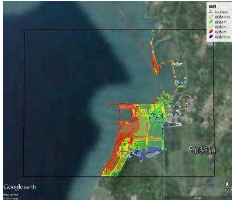
圖 5.30(g) 布袋港結合 Google Earth 之溢淹圖(DSM)，入射波高 10 公尺
