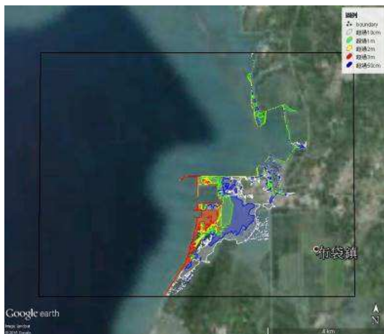
圖 5.30(f) 布袋港結合 Google Earth 之溢淹圖(DSM)，入射波高 6 公尺
