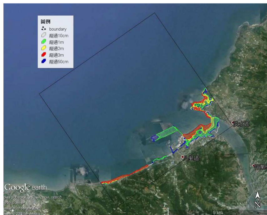
圖 5.41(d) 臺北港結合 Google Earth 之溢淹圖(DEM)，入射波高 3 公尺
