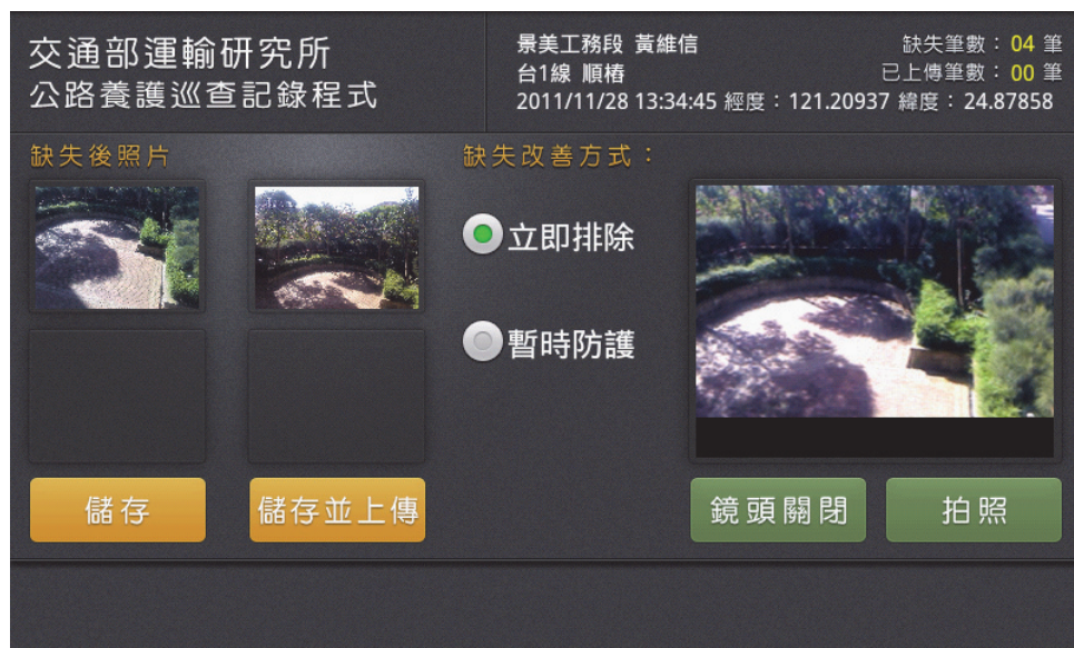
圖 3- 6 缺失改善/防護拍照功能
