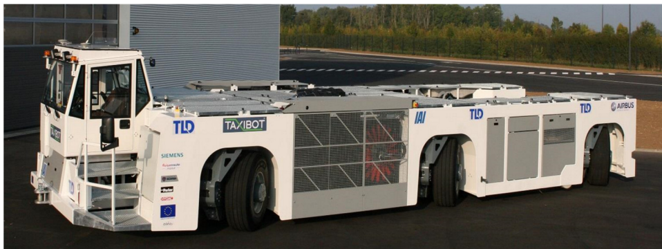
圖 28 TaxiBot 半自動式油電混合拖車
