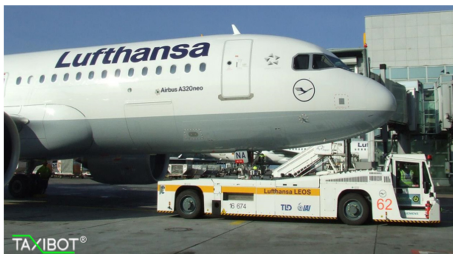
圖 29 航機由 TaxiBot 拖車帶動滑行
