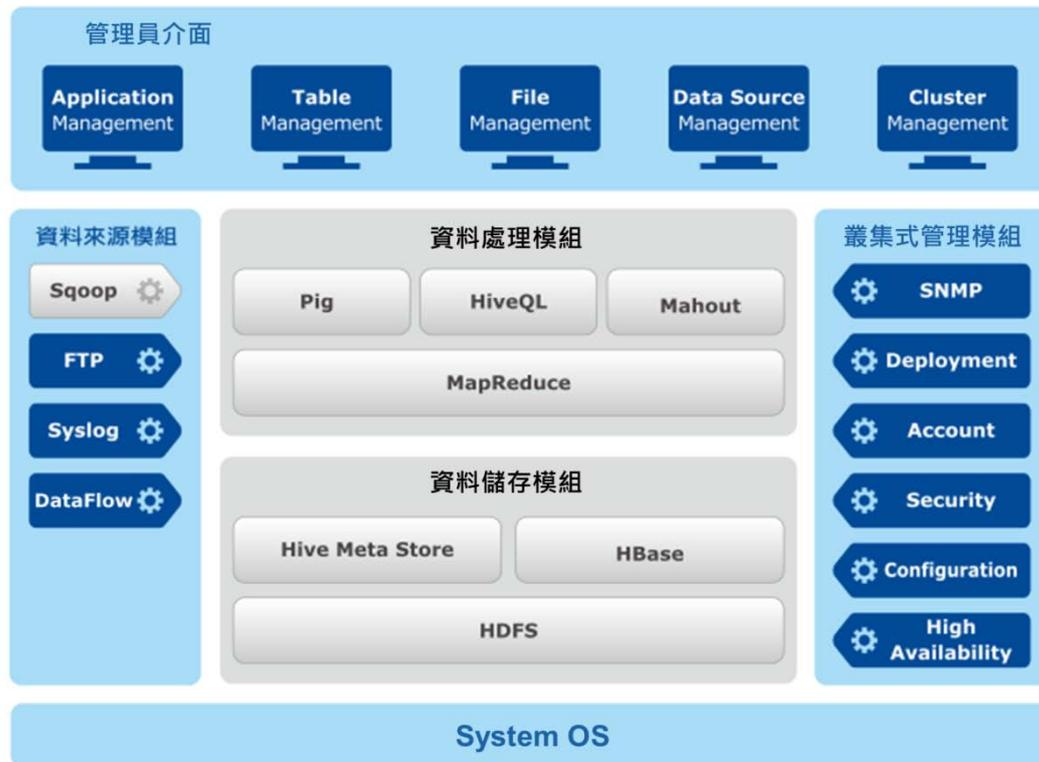
圖 5-46 軟體系統架構圖(基礎版)
