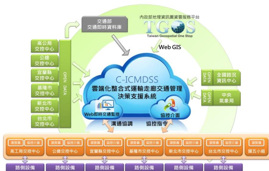
圖 2.1.14 C-ICMDSS 雲端運作架構示意圖
