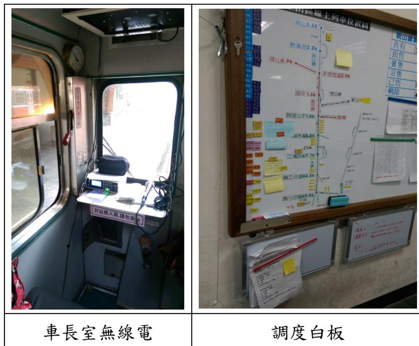
圖 4.6 森鐵行車調度系統
