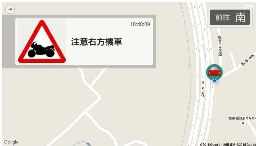
圖 7.3.5.2.2 機車盲點警示(V2V)UI 畫面
