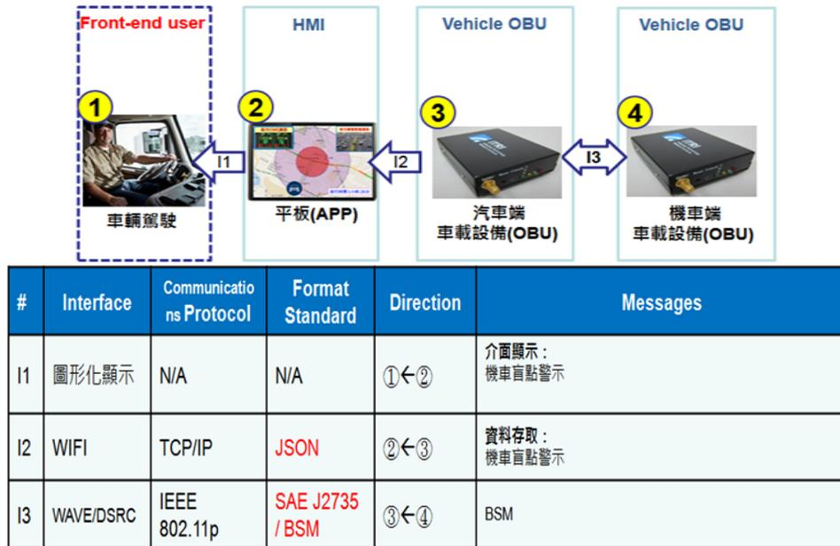
圖 6.3.19 機車盲點警示驗測情境之資訊交換示意圖
