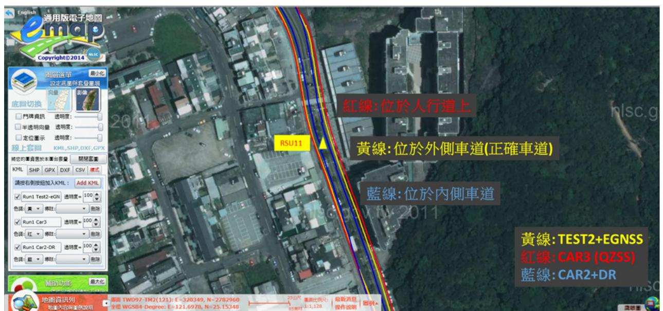
圖 7.3.2.3 Run1 行駛外側車道 OBU 軌跡圖(RSU11 附近)
