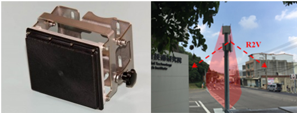
圖 3.2.72 毫米波雷達與安裝示意圖
