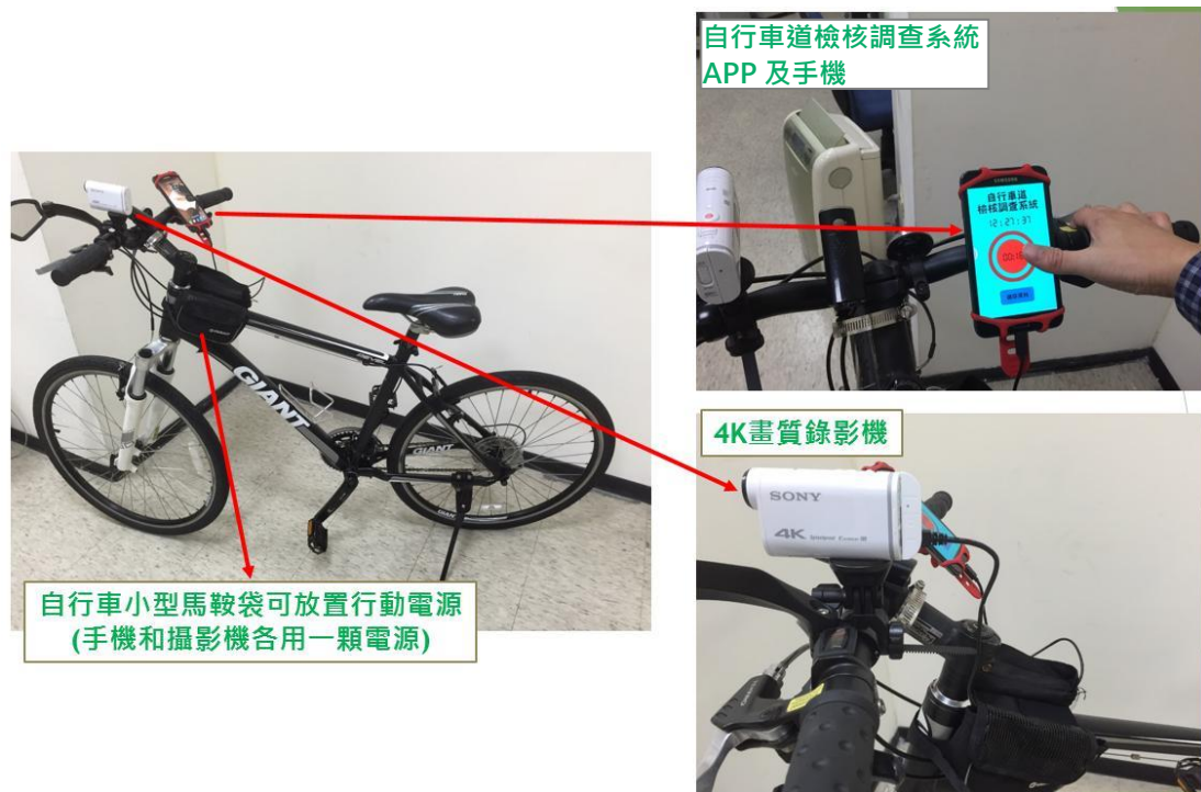
圖 5.6 自行車道環境檢核設備架設情形
