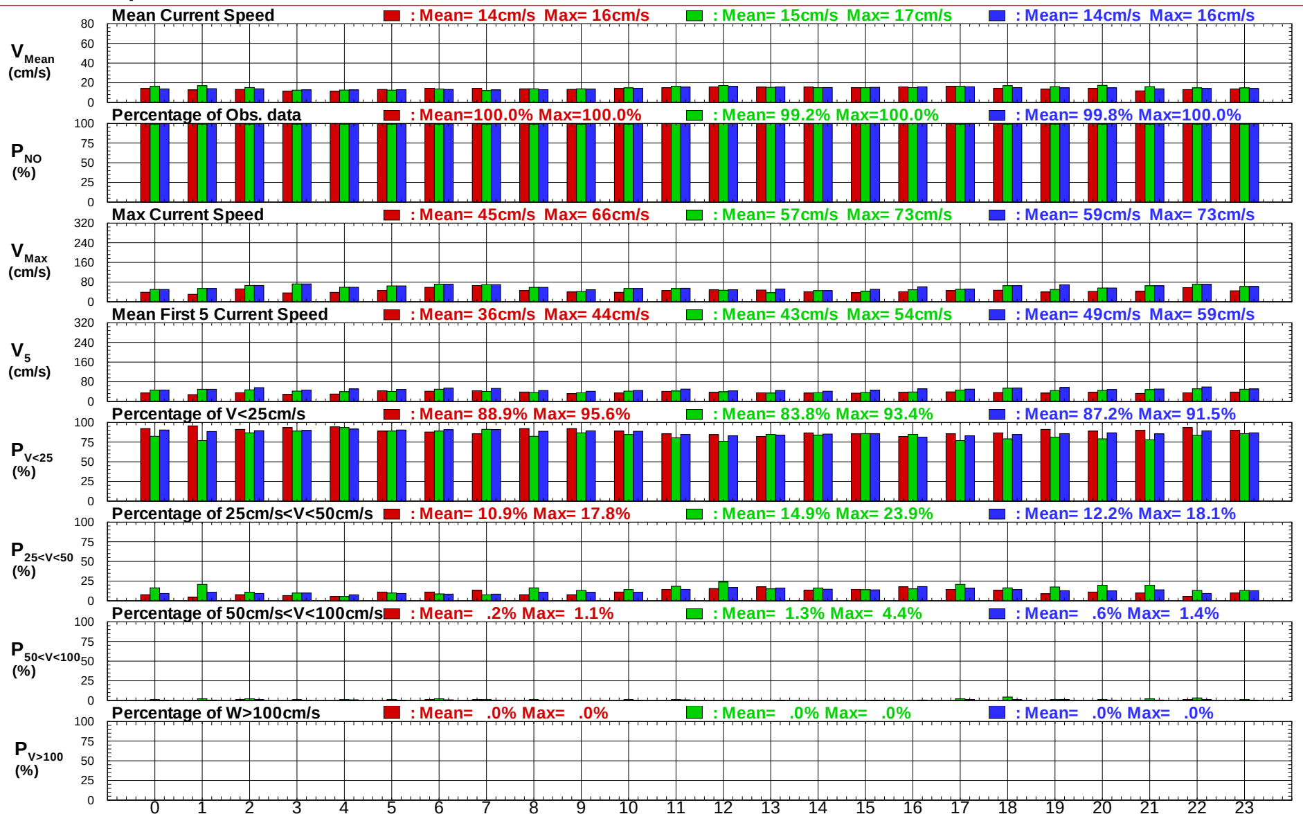
圖 4.3.2a 蘇澳港域2014冬, 夏及整年 X 站逐時流速統計量比較圖
