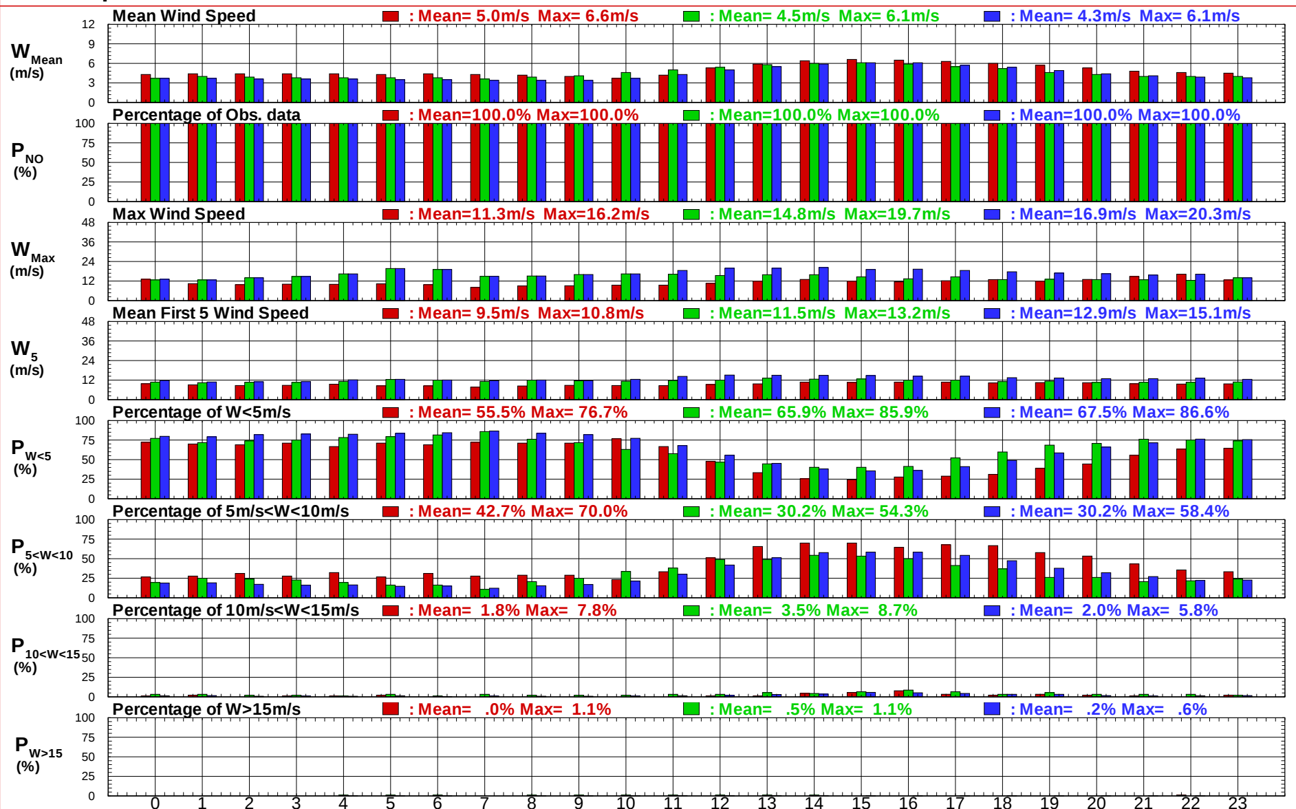
圖 1.3.2a 高雄港域2014冬, 夏及整年 X 站逐時風速統計量比較圖
