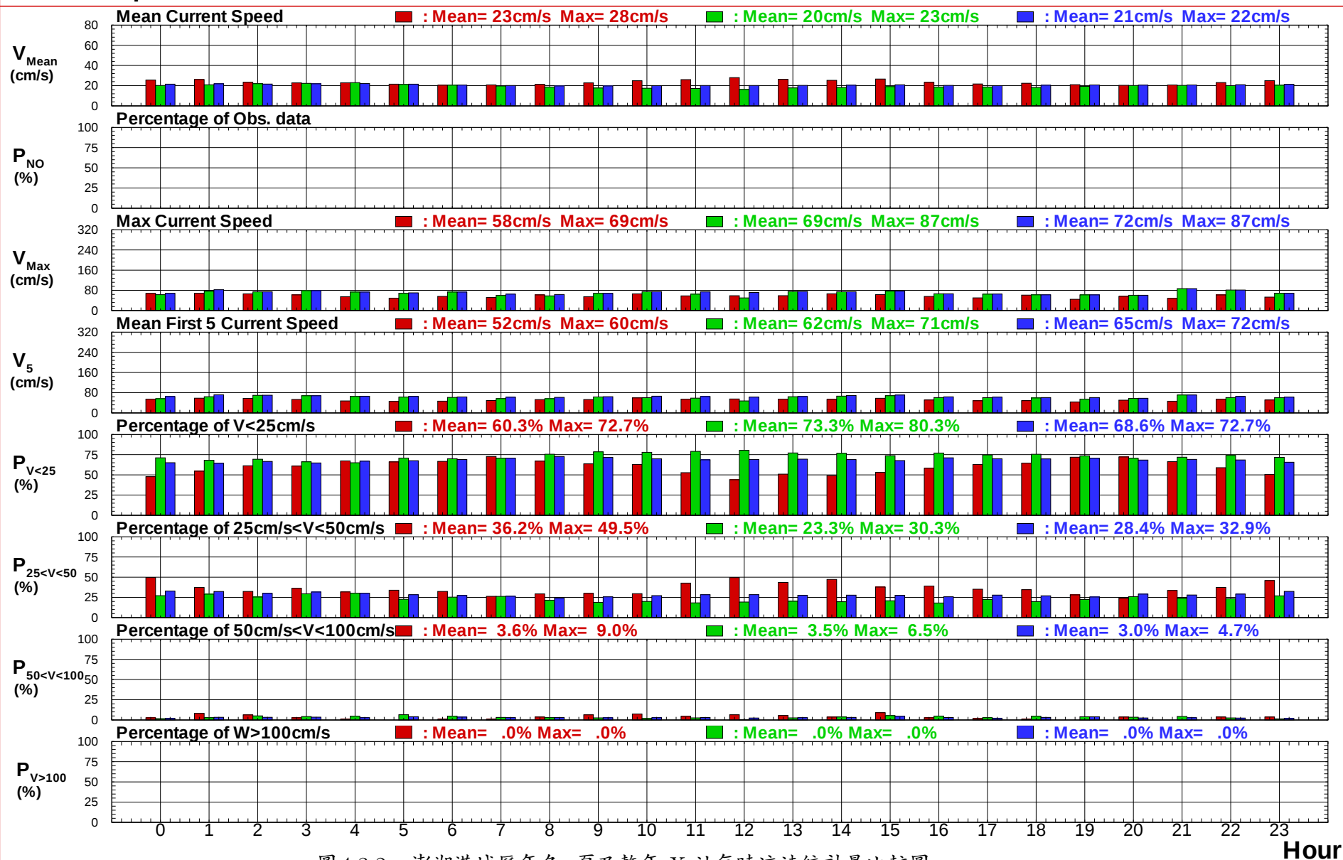
圖 4.3.2c 澎湖港域歷年冬, 夏及整年 X 站每時流速統計量比較圖
