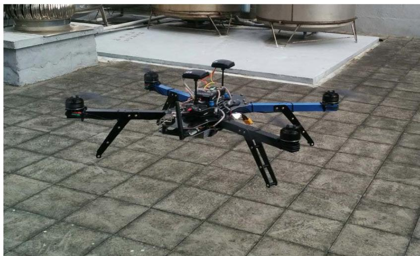
圖 4.8 測試雙 GPS 模組之 UAV
