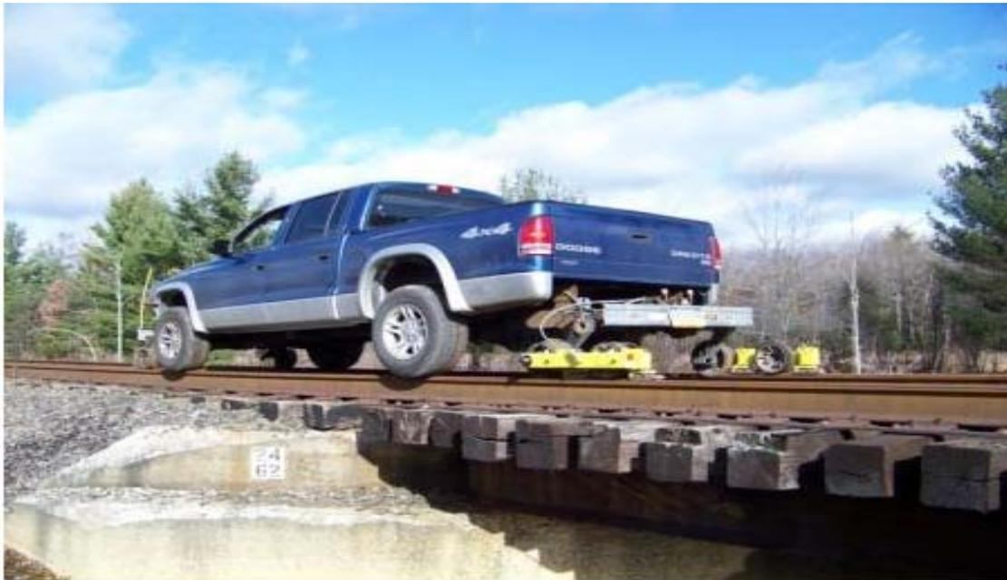
圖 2.19 超音波鐵路橋檢測車
