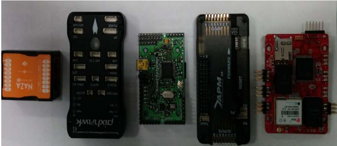
圖 3.1 前期計畫所比較的不同飛行控制器
