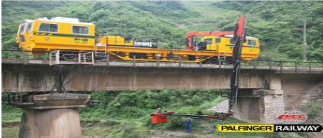
圖 2.4 吊籃式橋梁檢測車
