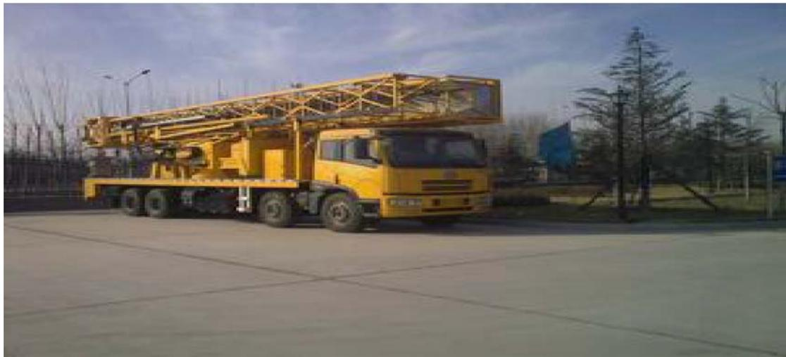
圖 2.5 桁架式橋梁檢測車
