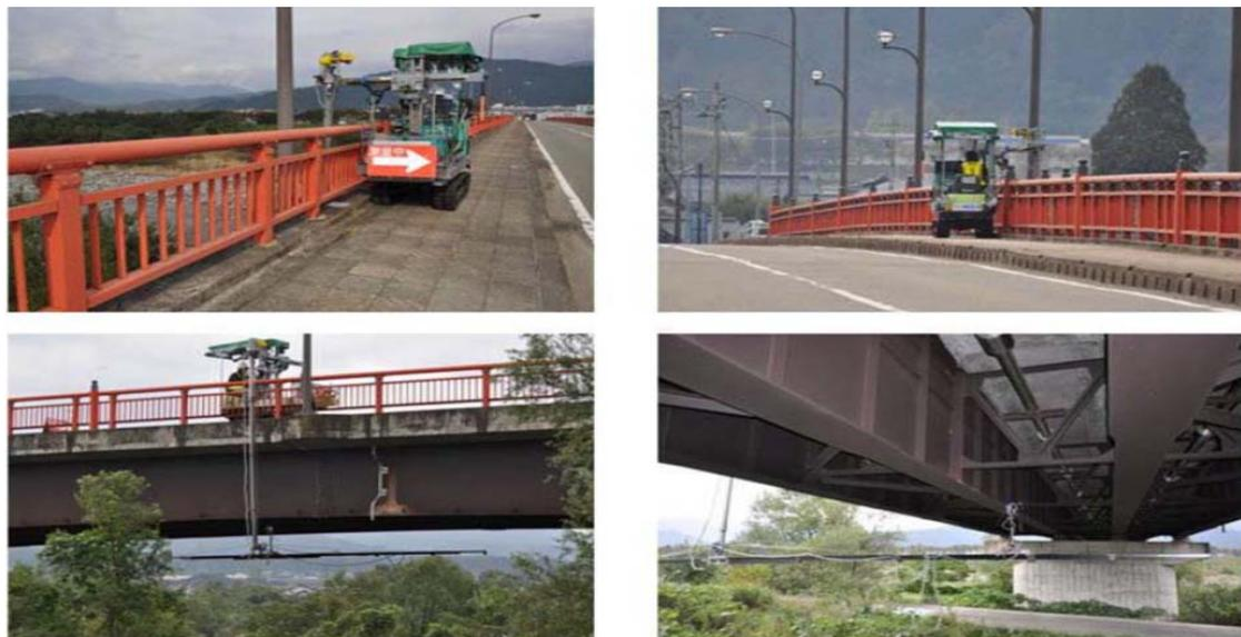
圖 2.6 迷你型橋梁檢測電動車
