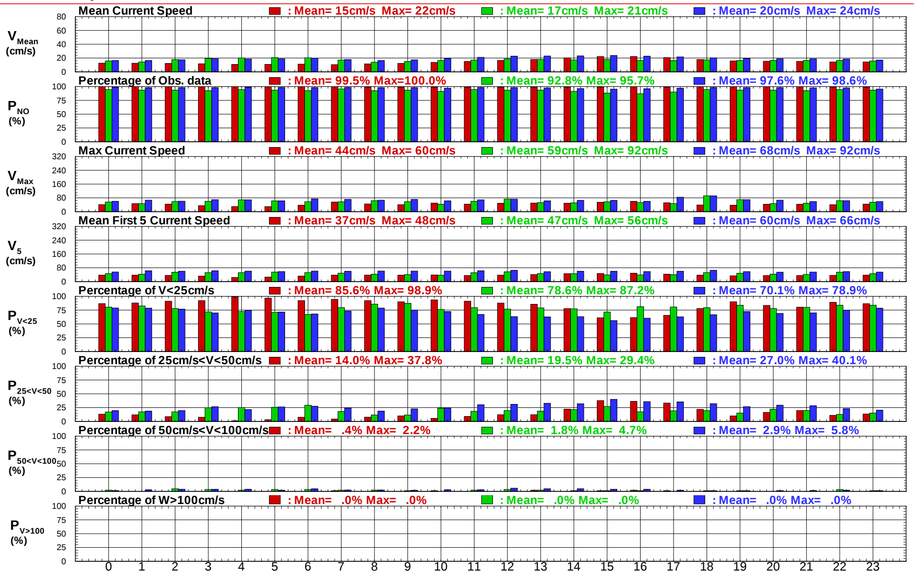
圖 4.3.2a 高雄港域2016冬, 夏及整年 X 站逐時流速統計量比較圖
