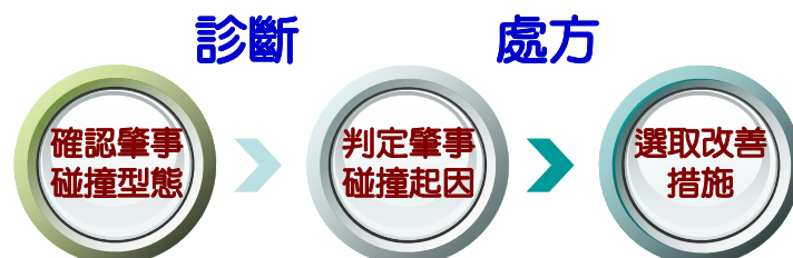
圖 3-2 易肇事路口改善的診斷與處方相連結架構
