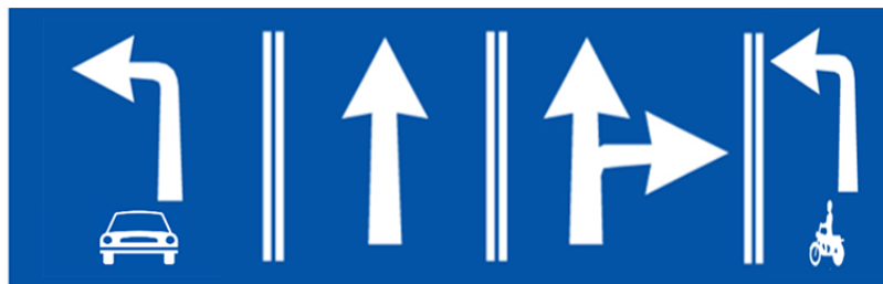
圖 8. 機車左轉專用道設置於外側車道之標誌牌
