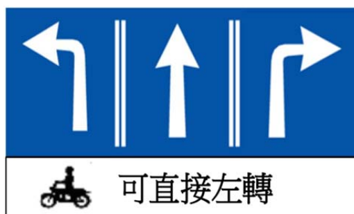
圖 5-17 「輔一」標誌牌及附牌
