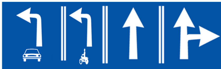
圖 6. 機車左轉專用道設置於內側車道之標誌牌
