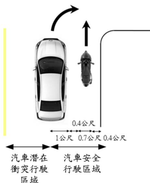
圖 3-16 汽機車併行所需最小淨間距
