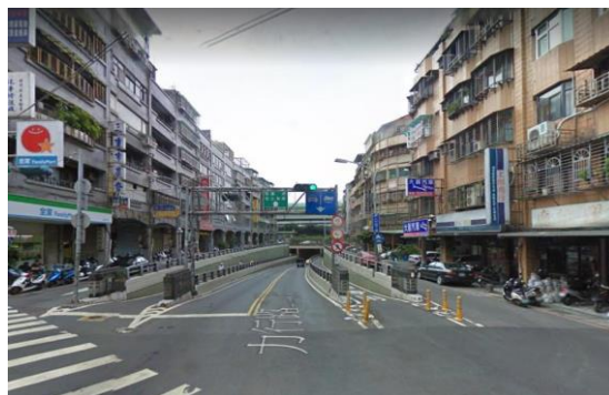
圖 10.6 新北市三重區力行路地下道之車道配置（1 快車道/禁行機車、1 機車專用道）
