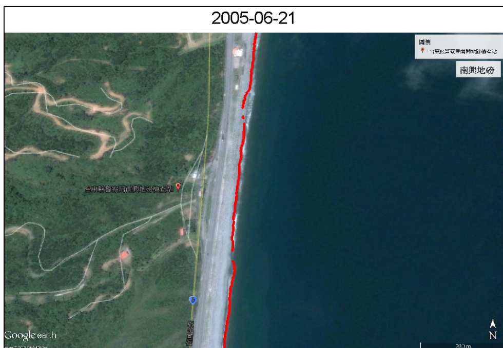
圖 3.7a 南興地磅站 2005 年衛星影像邊緣偵測
