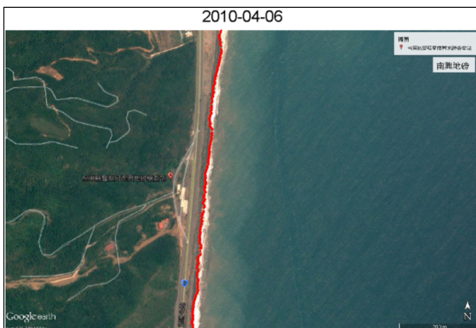
圖 3.7b 南興地磅站 2010 年衛星影像邊緣偵測
