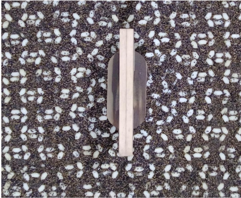
圖 6.37 蛇籠+織物模板+基礎附近鼎形塊鋪滿
