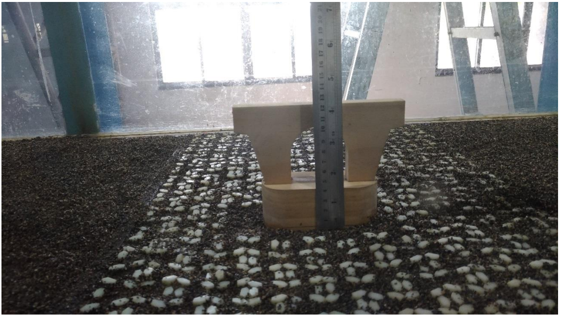
圖 6.3 橋墩鋪設情形
