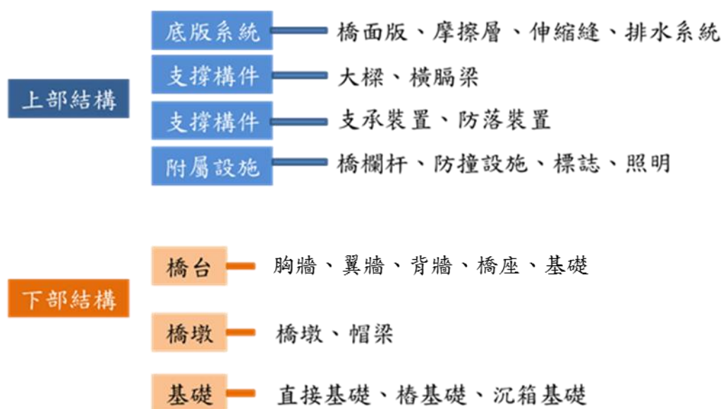
圖 2.4 橋梁分為上部結構與下部結構
