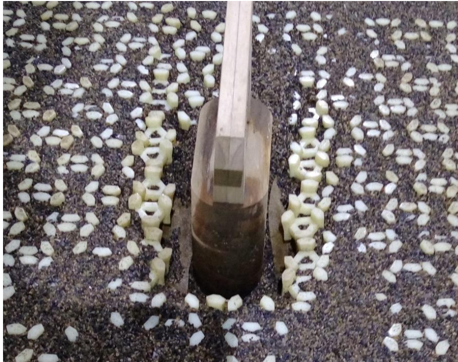
圖 6.17 織物模板(底床下 4 公分)基礎沖刷情形
