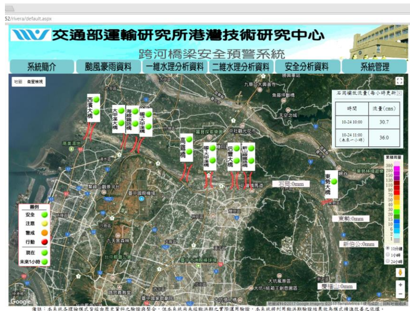
圖 4.7 跨河橋梁安全預警系統網頁
