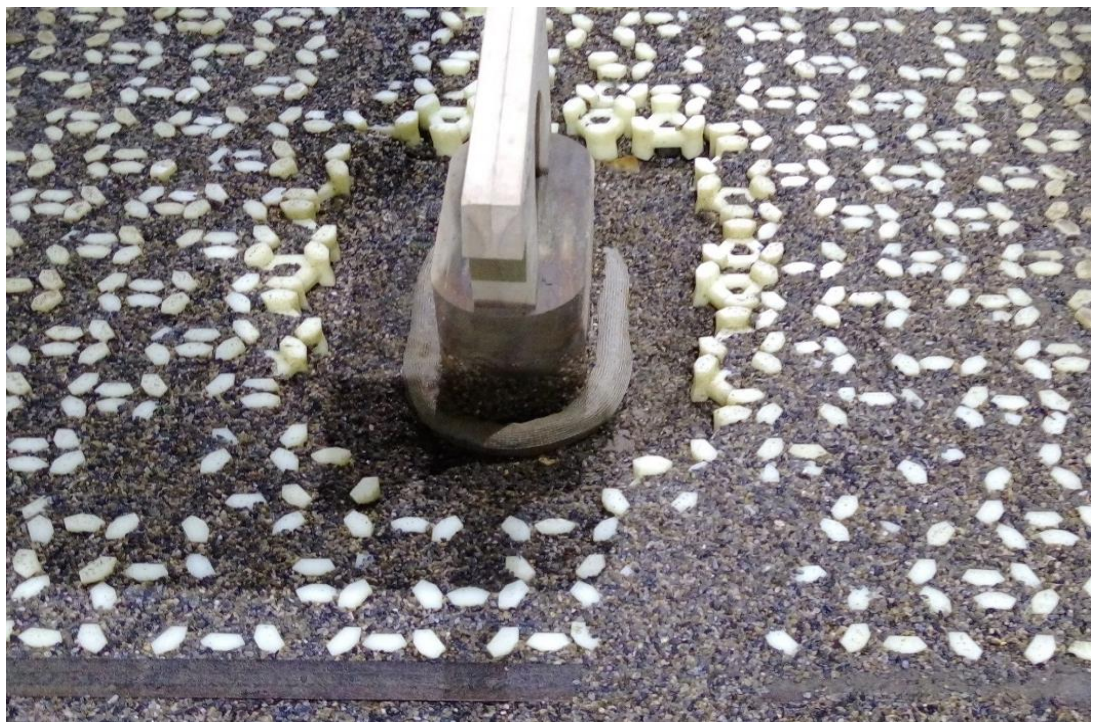
圖 6.32 蛇籠+織物模板+鼎形塊移除 1 排基礎沖刷情形
