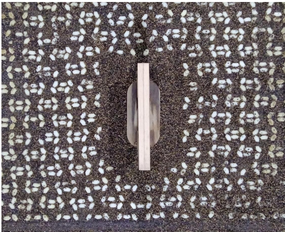
圖 6.30 蛇籠+織物模板+基礎附近鼎形塊移除 1 排
