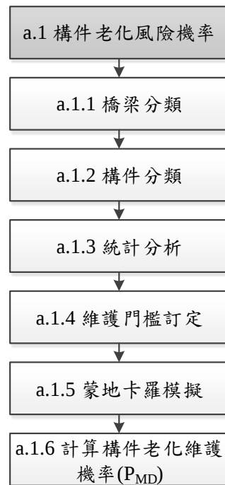
圖 2.3 構件老化風險機率評估流程圖
