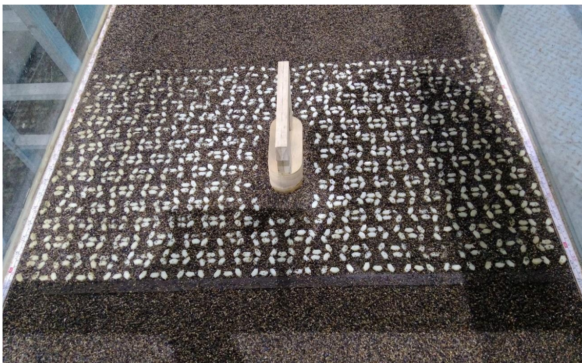
圖 6.7 原保護措施模型鋪設
