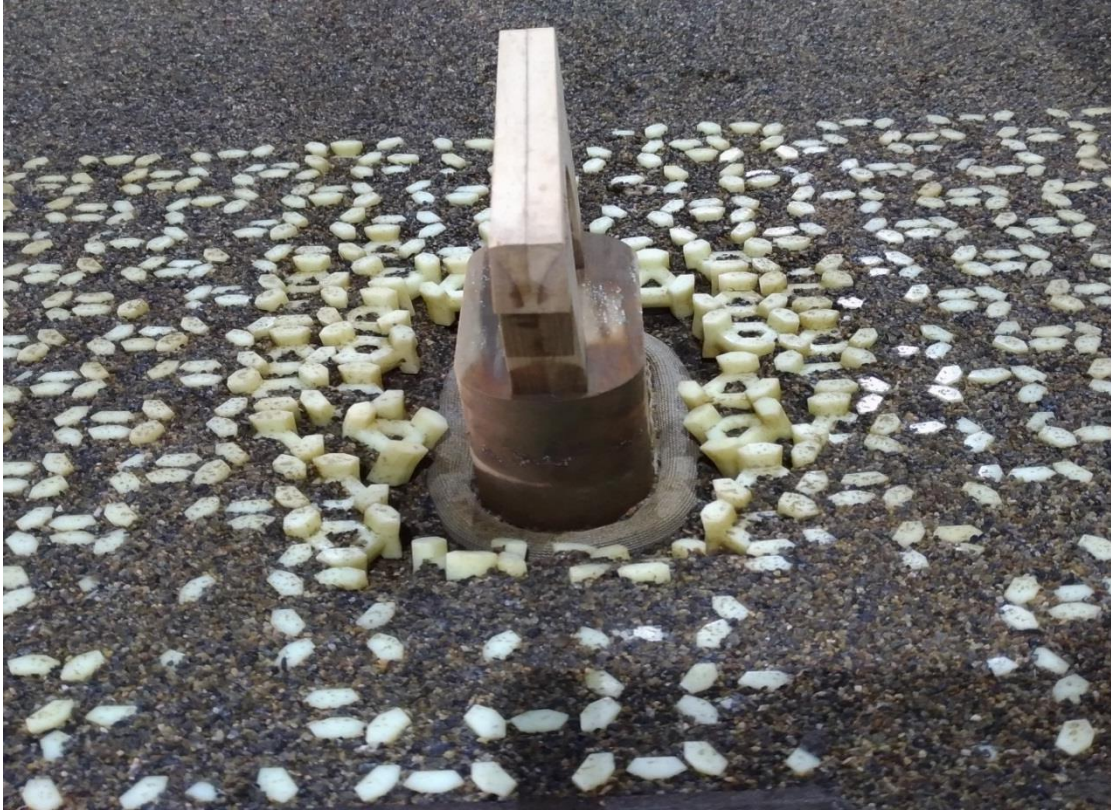
圖 6.25 蛇籠+織物模板基礎沖刷情形
