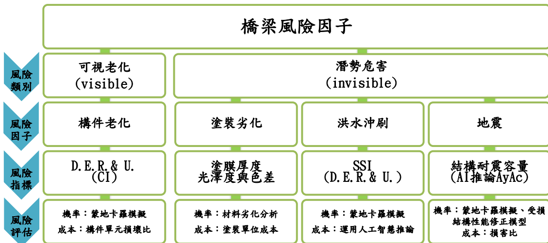
圖 2.1 鋼橋風險評估架構
