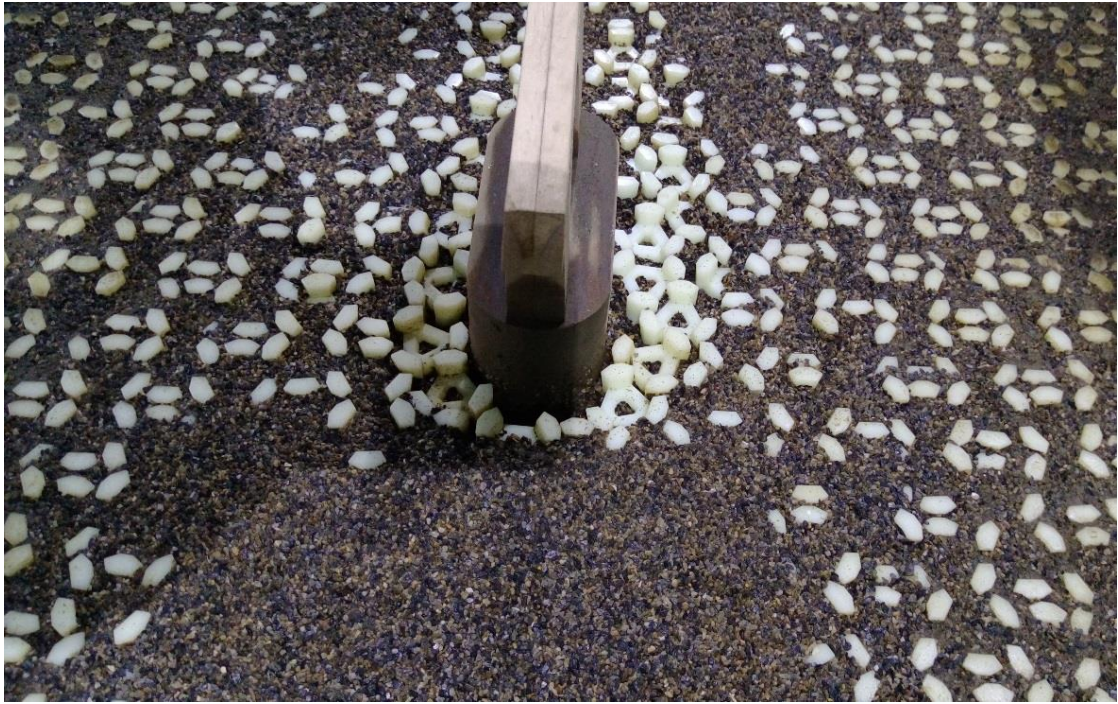
圖 6.39 蛇籠+織物模板+鼎形塊鋪滿基礎沖刷情形
