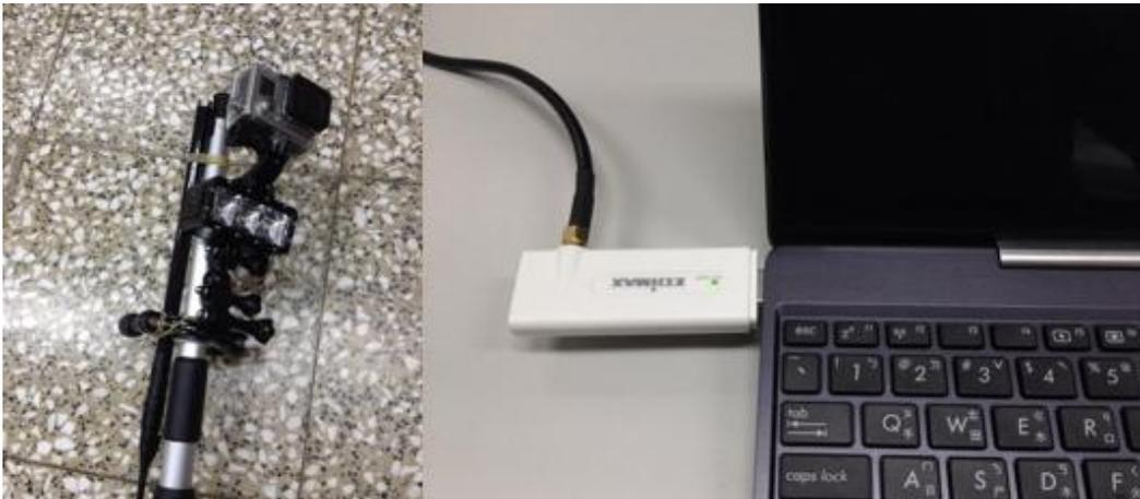
圖 5.4 長桿檢測工具裝設 WIFI 延長天線與電腦做連接
