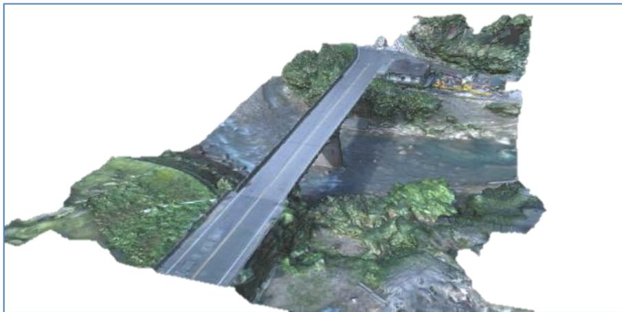
圖 4.9 由 UAV 影像產製之橋梁三維模型
