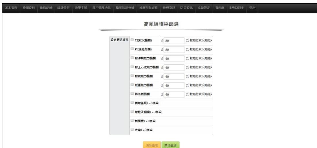
圖 2.5 第二代臺灣地區橋梁管理資訊系統之篩選高風險橋梁清單畫面
