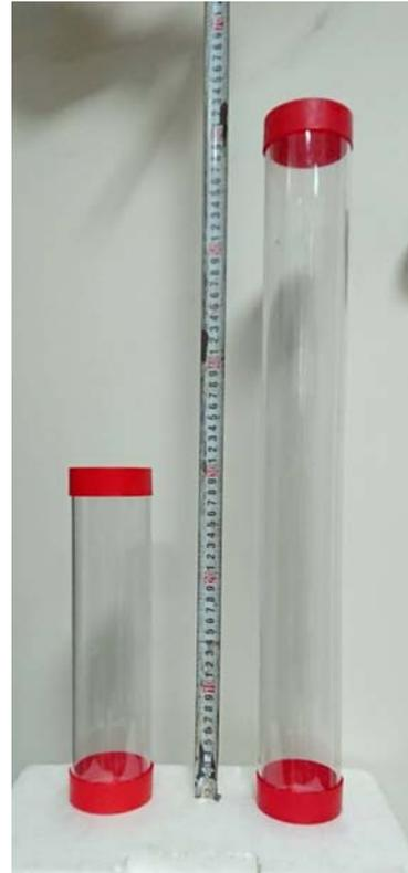
圖 5.5 底泥採樣岩心管
