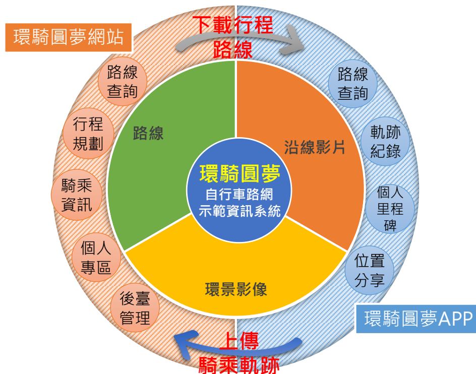
圖 4.1.1 環騎圓夢自行車路網示範資訊系統架構
