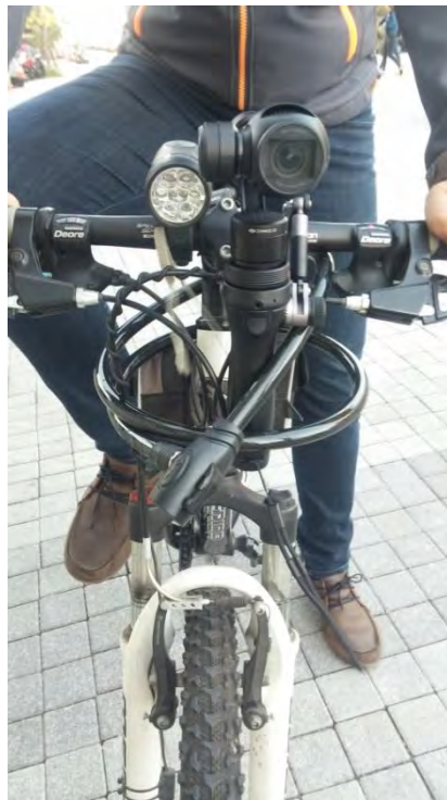
圖 4.2.2 三軸雲臺相機架設方式
