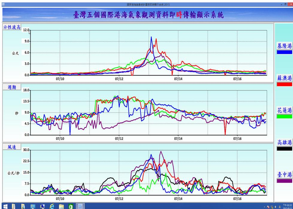
圖 3-2 蘇力颱風(2013/07)之移動路徑(上)與國內五個國際港近海監測風浪之逐時紀錄分析(下：上\_示性波高；中\_尖峰週期；下\_風速)
