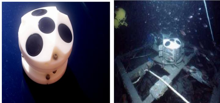
圖 2-2 挪威 NORTEK 公司出品同時掛載有壓力計(Press.)及聲波計(AST)之超音波式波向波高與剖面海流儀(AWAC)
