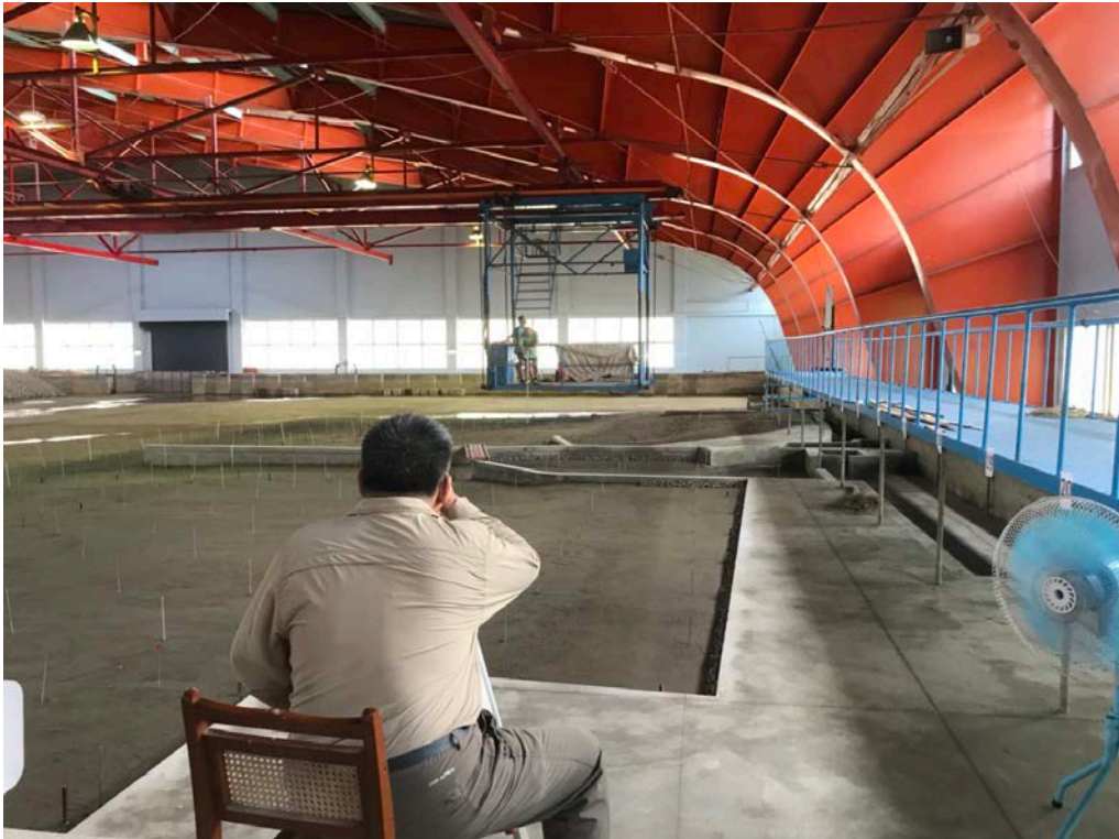
圖 2.25 以水準儀量測初期地形
