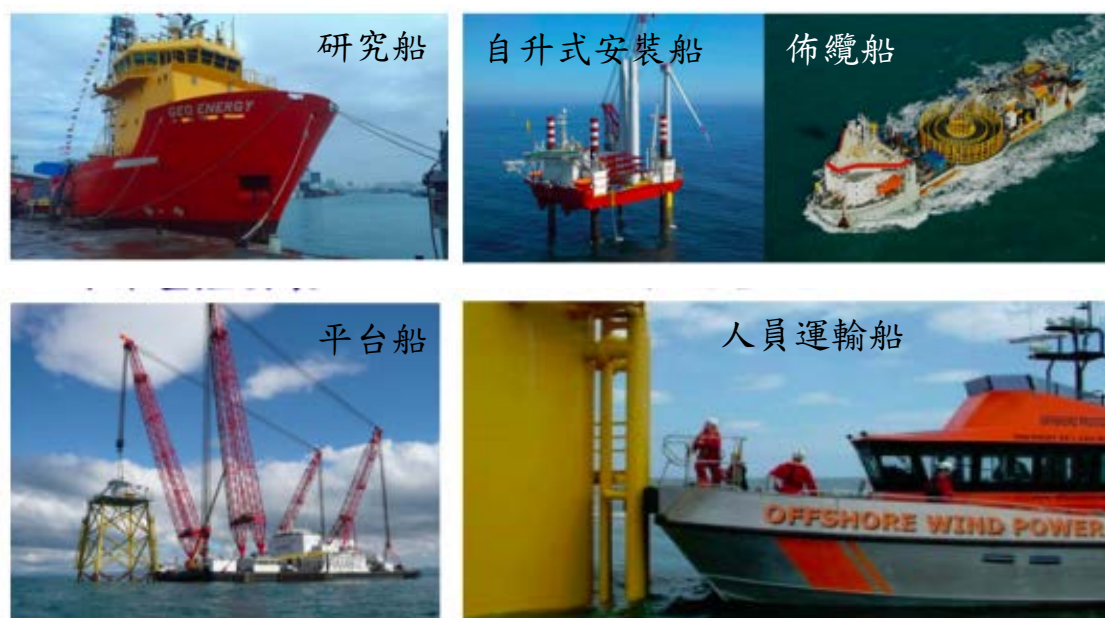
圖 4.5 離岸風場施工船隊關鍵船機
