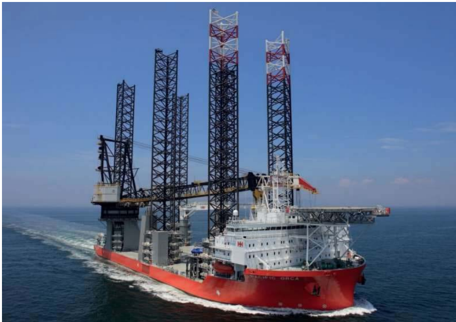
圖 5.1 水下基礎施工船舶圖
