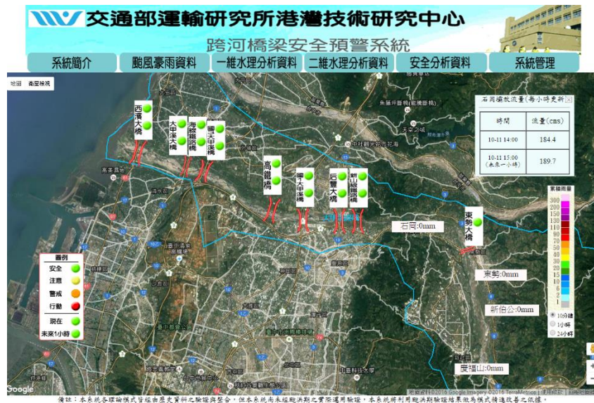
圖 2.10 跨河橋梁安全預警系統畫面
