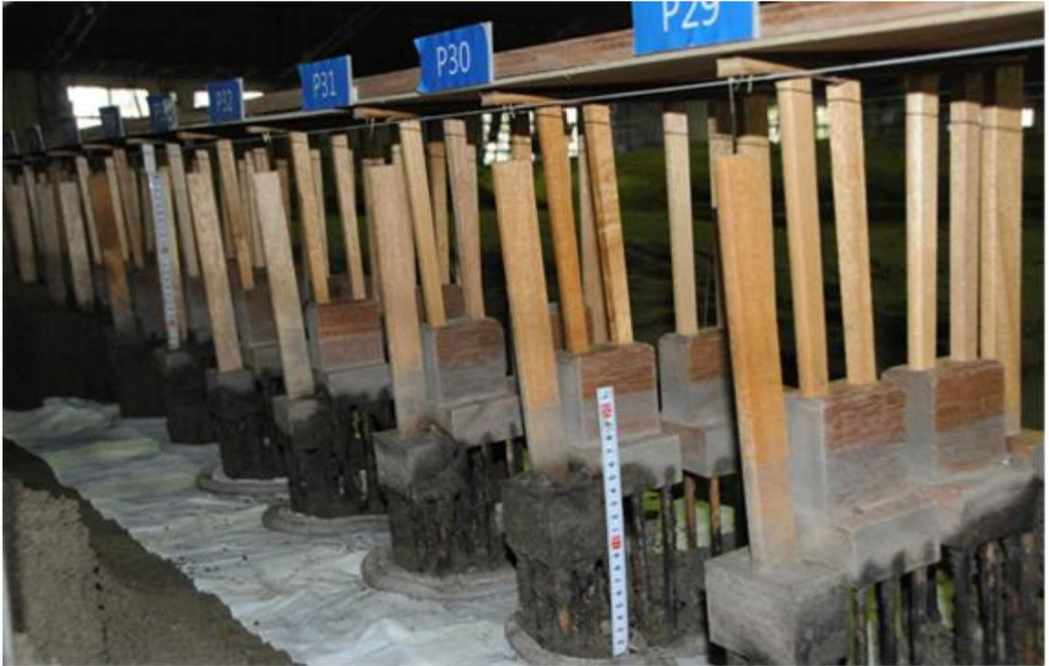
圖 2.24 方案 2 保護工佈設深度(基礎底部往下 13 公分)
