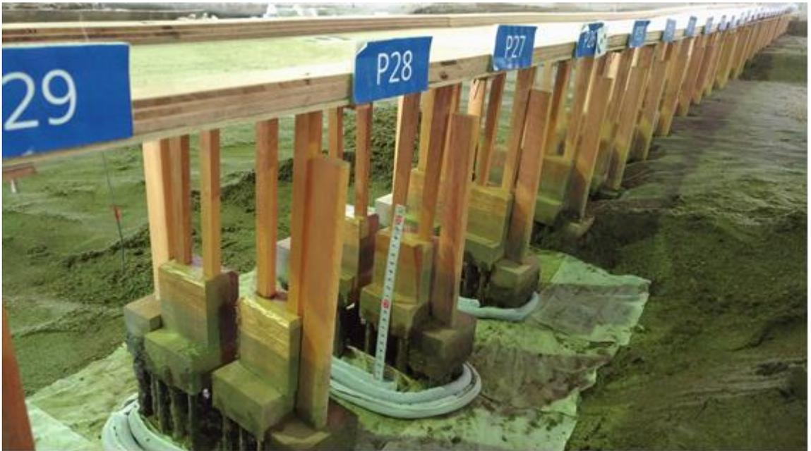
圖 2.23 方案 1 保護工佈設深度(基礎底部往下 8 公分)
