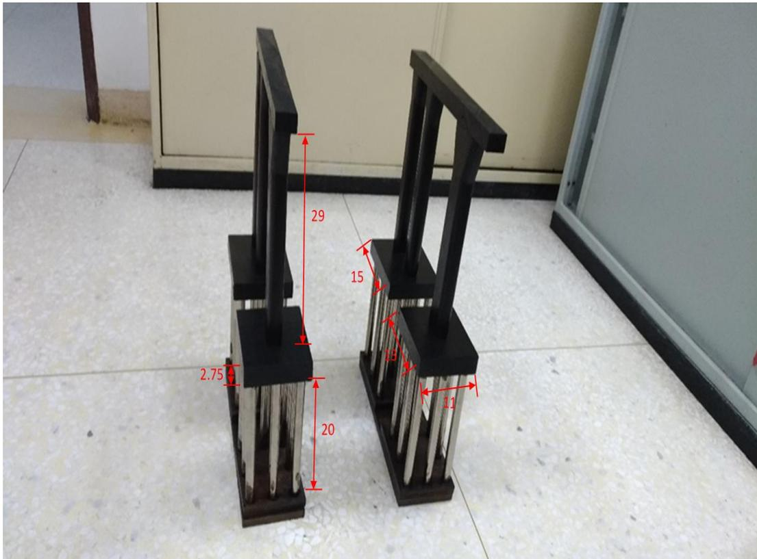
圖 5.10 試驗橋墩模型照片
