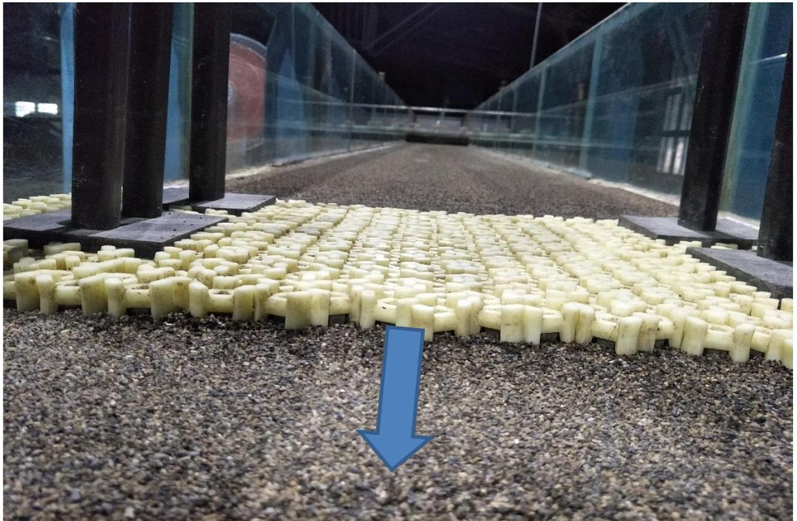
圖 6.33 方案二(一層鼎形塊+織布)保護措施模型鋪設
