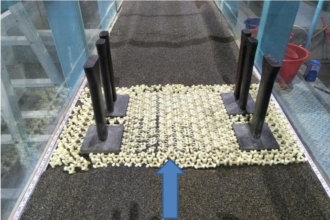
圖 6.24 方案一(一層鼎形塊)保護措施上游基礎沖刷情形
