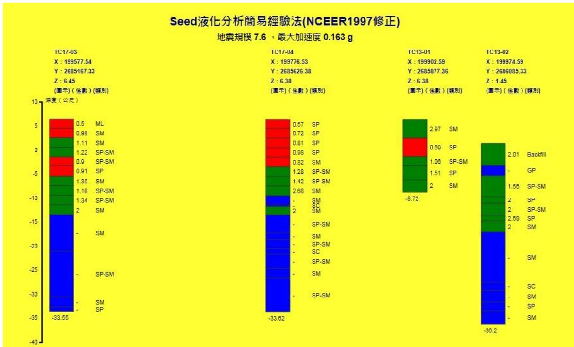
圖 3.8 鑽探液化柱狀圖 (Seed-由西向東排序)
