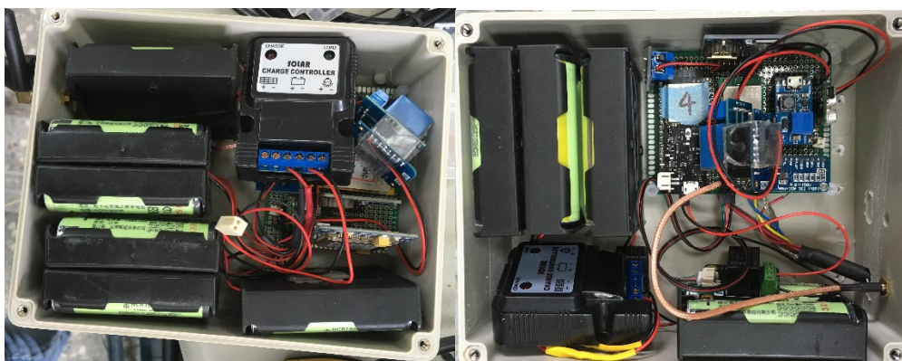
圖 3.29 防水電子盒內部配置 (左:伺服器端, 右:客戶端)
