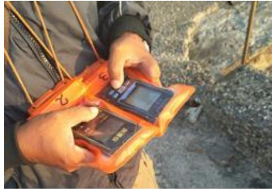
圖 3.12 兩臺 GPS 系統同步定位
