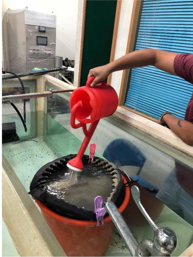
圖 4.85 砂子以自由貫落法鋪設過程
