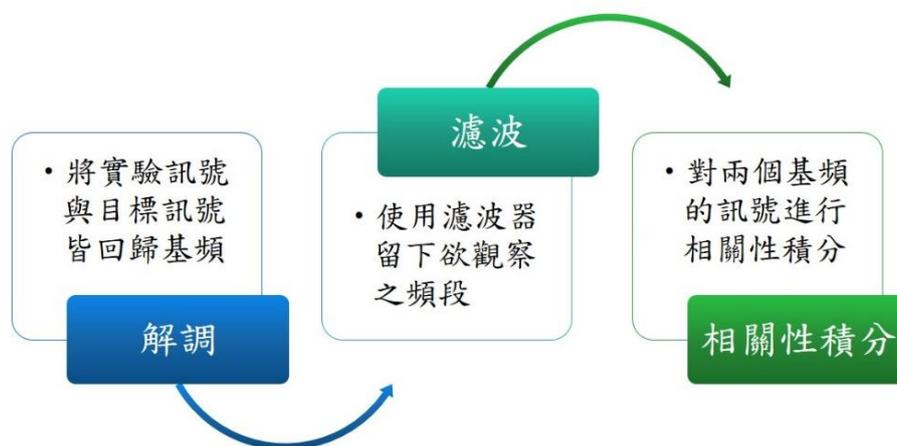
圖 4.11 脈衝壓縮(Pulse compression)流程圖
