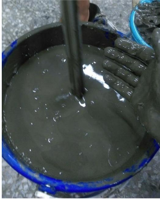
圖 4.81 攪拌均勻後的海底泥
