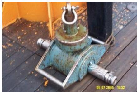
圖 4.17 沉積物採樣器(SHIPEK Grab Sampler)
