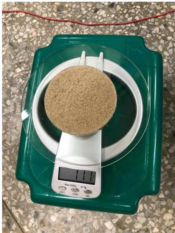
圖 4.97 砂子密度量測情形
