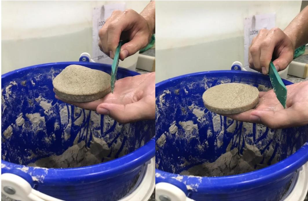
圖 4.96 (a)將密度盒取出時的情形。(b)將密度盒上方突出的部分刮平，再進行質量量測
