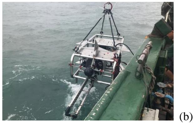
圖 4.31 第三組實驗位置圖，(a)基隆碧砂漁港外實驗位置圖、(b)拖曳式多頻率海床探測聲學系統
