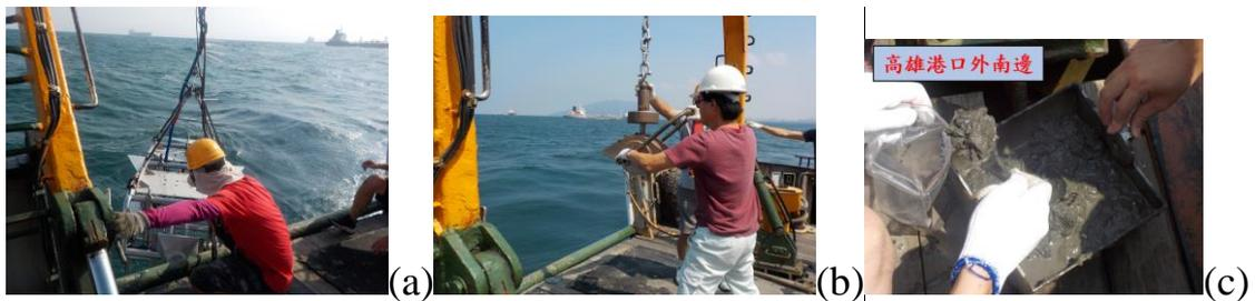
圖 4.36 第五組實驗過程圖，(a)拖曳式自收發聲納系統佈放情形、(b)底質採樣過程、(c)海床樣本
