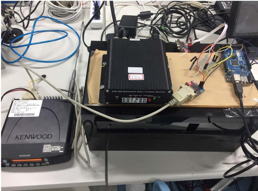
圖 6.11 AIS 行動中繼傳輸系統傳送端
