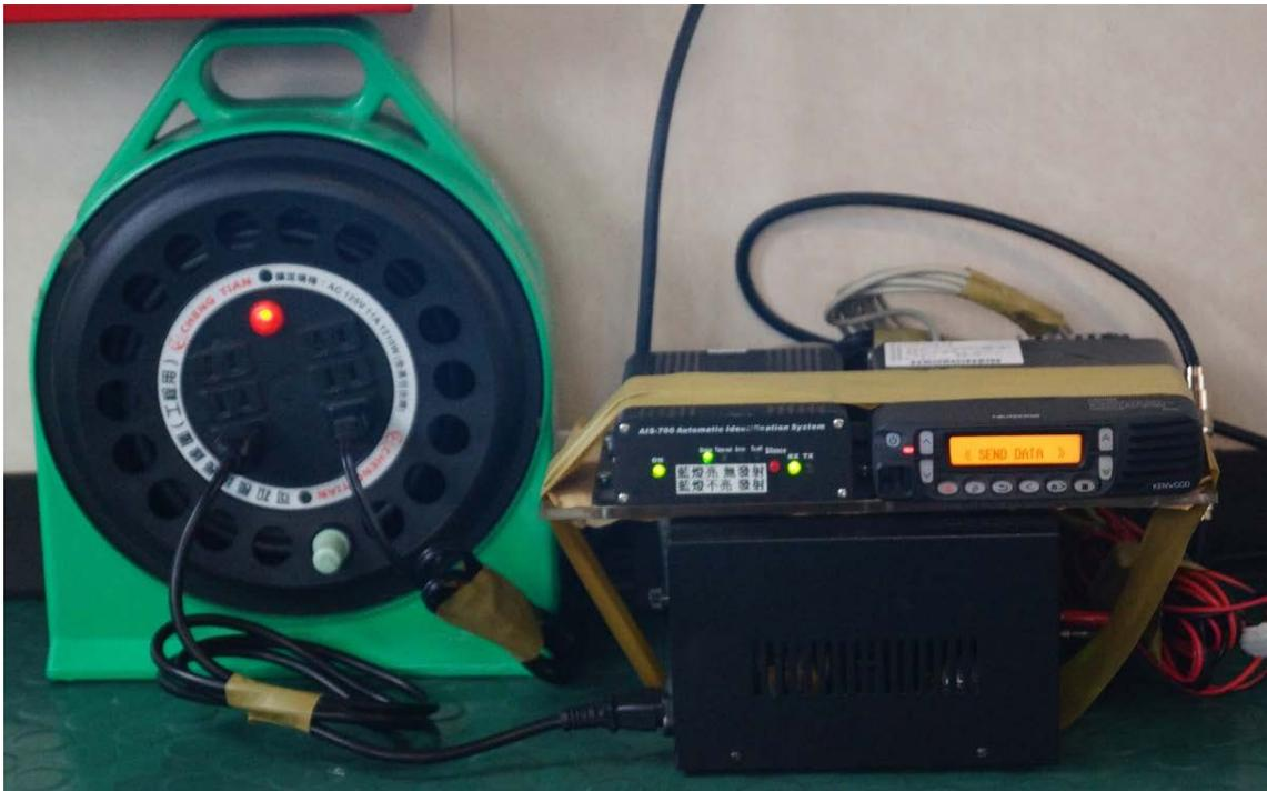
圖 6.14 臺馬之星上 AIS 中繼傳送端設備實體
