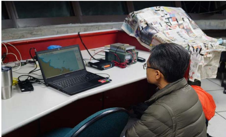
圖 6.20 於航管中心監測 AIS 中繼接收端的訊號接收情形
