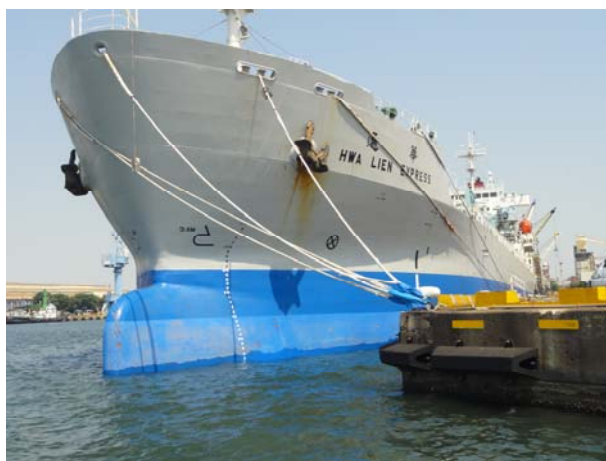
圖 2.11 散裝船船頭繫纜方式
