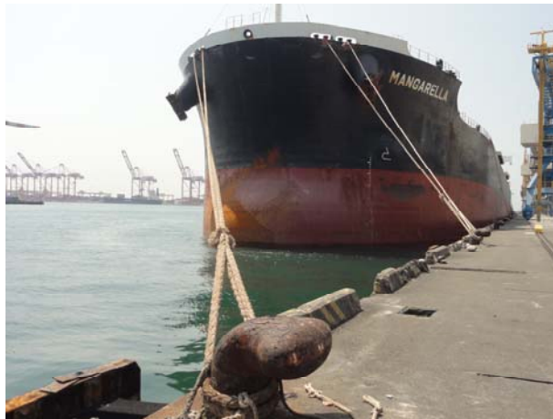
圖 2.8 五穀雜糧船船頭繫纜方式
