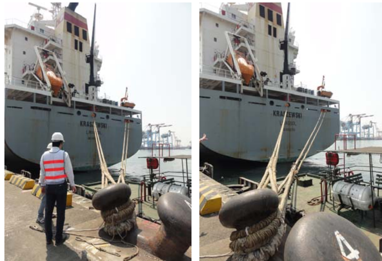
圖 2.6 散裝船船尾繫纜方式
