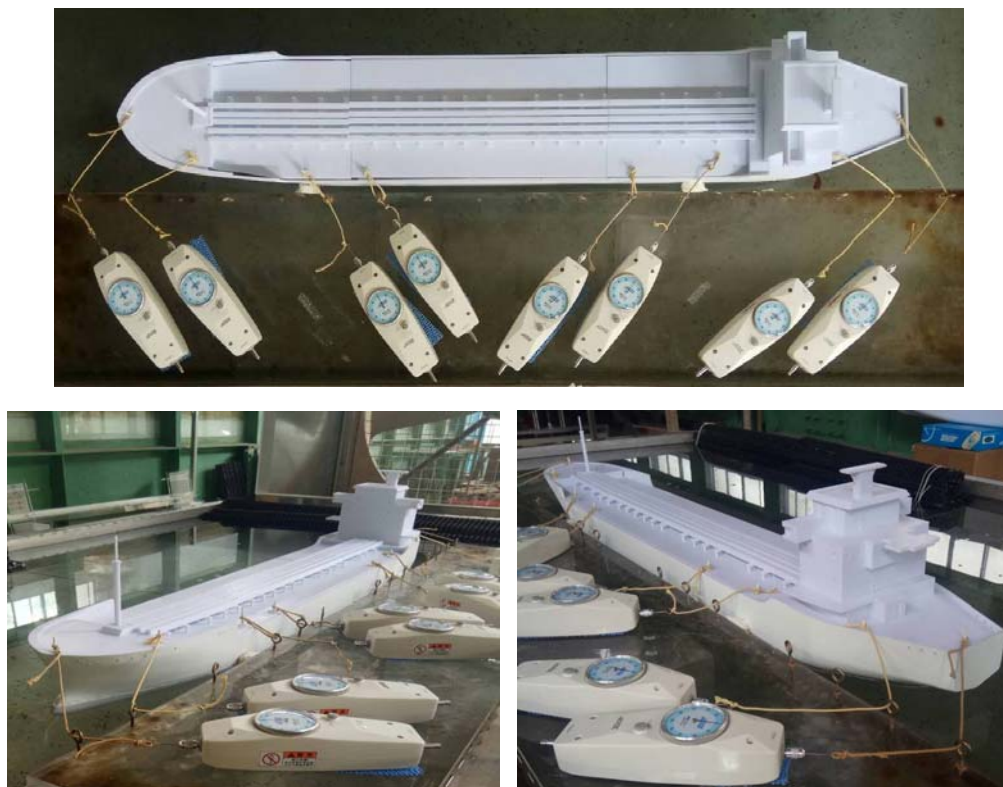
圖 4.17 油輪風力試驗之繫纜配置（8 條）
