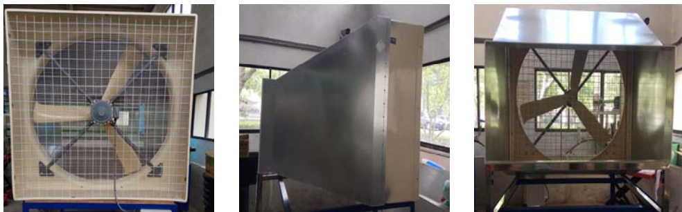
圖 3.5 為強力風扇（左），導風流道（中），出風口（右）
