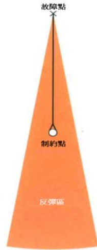
圖 1 簡單繫泊系統，已顯示潛在的「反彈」區範圍
