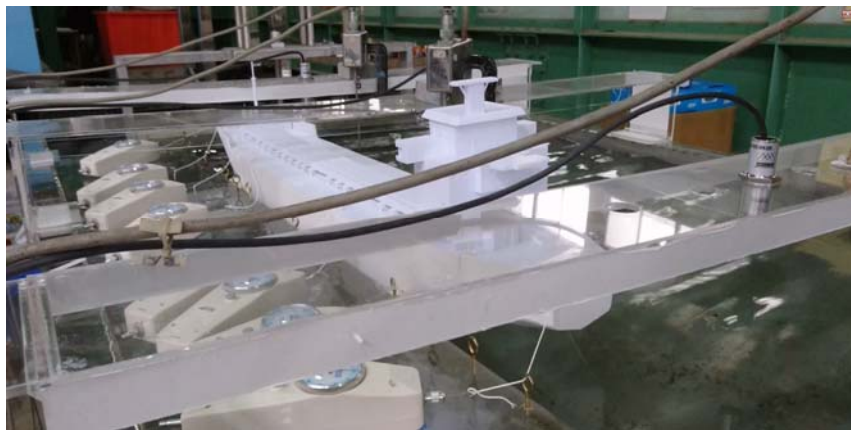
圖 4.6 波高計設置照片（一）
