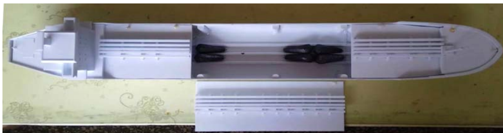
圖 3.9 油輪船甲板上蓋及配重鉛塊之照片
