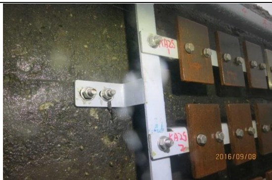
5.飛沫帶試驗架組裝完成
