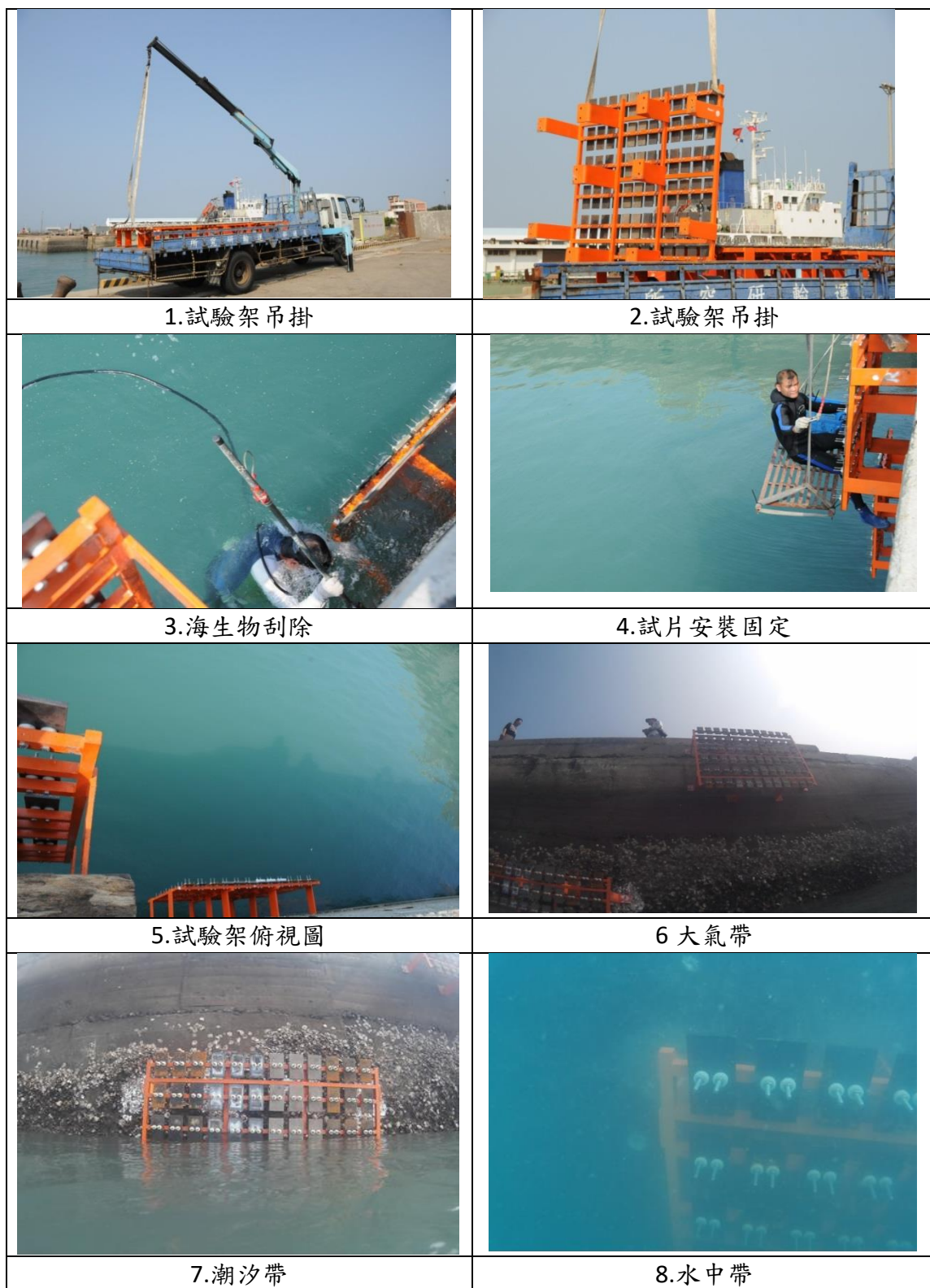
圖 3.5 臺中港水下金屬曝露試驗架安裝
