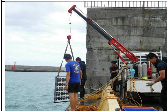
3.車用吊桿吊放金屬腐蝕試驗架
