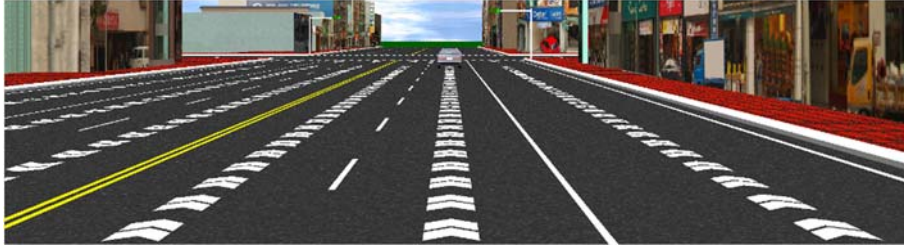
圖 6-4 實驗路段之新式減速標線 I
