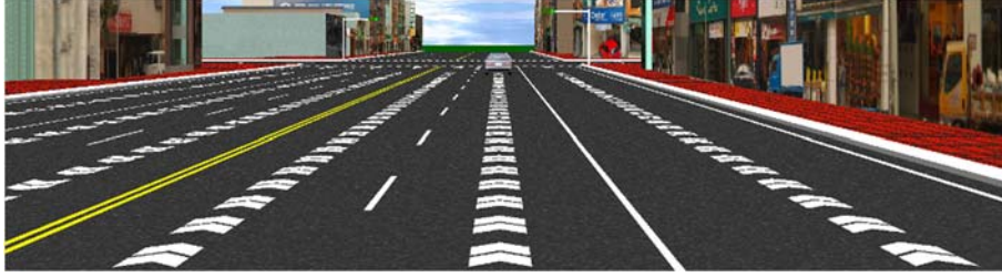
圖 4 實驗路段之新式減速標線 I
