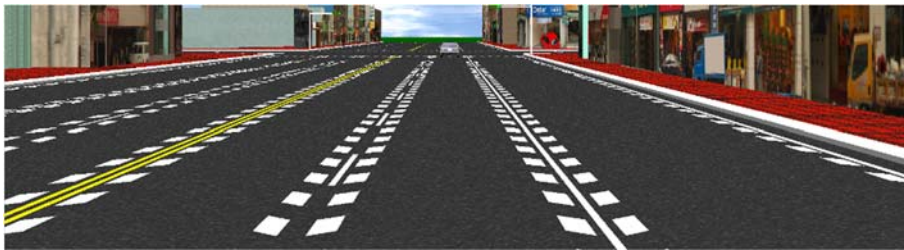
圖 5 實驗路段之新式減速標線 II
