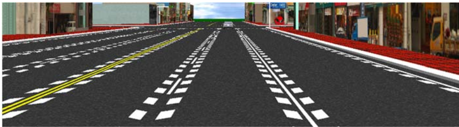
圖 6-5 實驗路段之新式減速標線 II
