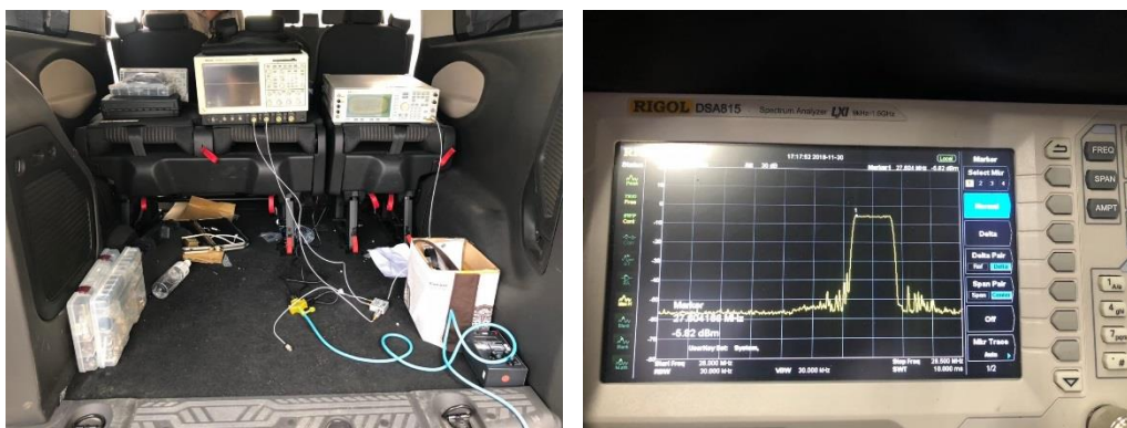
圖 4.13 雷達訊號衰減的量測情形
