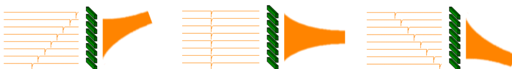
圖 3.5 雷達相控陣示意圖
