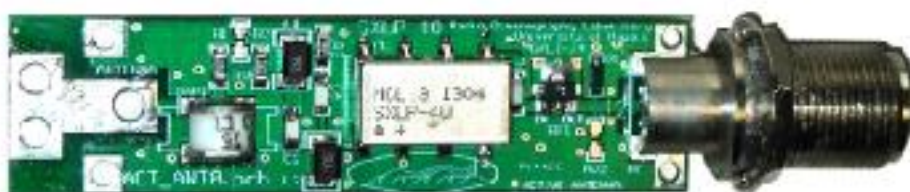
圖 4.6 主動式接收天線的低噪訊號放大器
