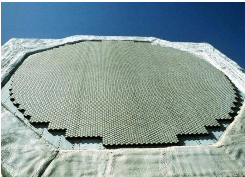
圖 3.6 相控陣雷達陣元佈置情形
