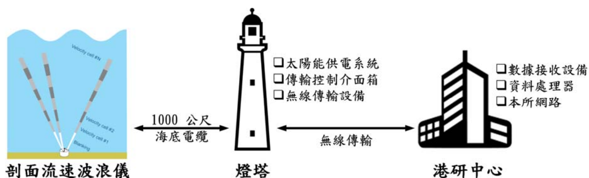
圖 2.1.7 底碇式波流觀測系統資料傳輸原理示意圖
