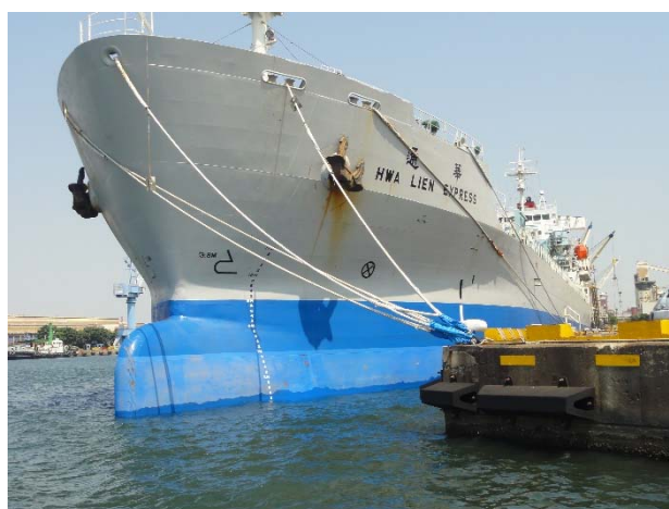
圖4.16散裝船船頭繫纜方式
