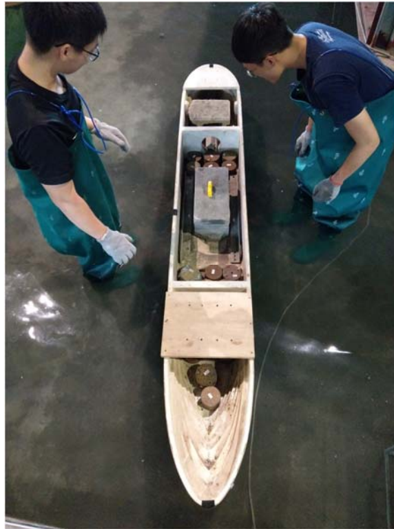
圖 5.11 模型船配重方式
