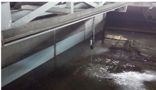
圖 5.18台車上架設波高計
