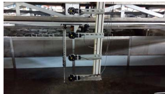
圖 5.19台車上架設風速計
