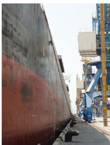
圖4.14五穀雜糧船橫纜繫纜方式
