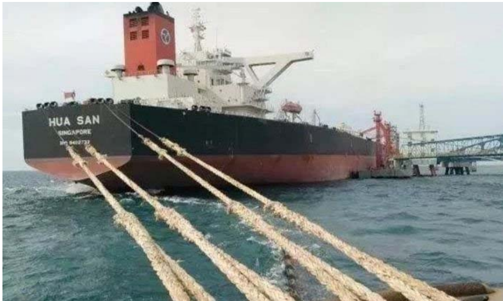
圖 3.3 纜繩外觀破舊、老化
