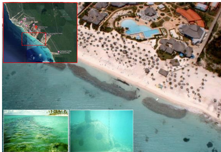
圖 2.1.11 國內離岸潛堤
