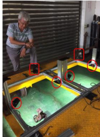
圖 3.20 以鋁擠型架固定燈具情形
