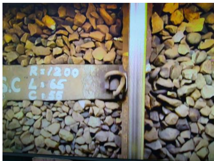
圖 4.10 一邊兩盞 200W 照明燈而且降低光源，取像結果清晰可用
