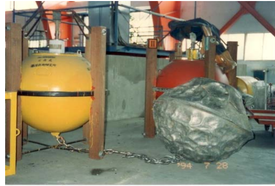
圖 2.1.3 荷蘭 Datawell 公司生產之浮球式波高波向儀
