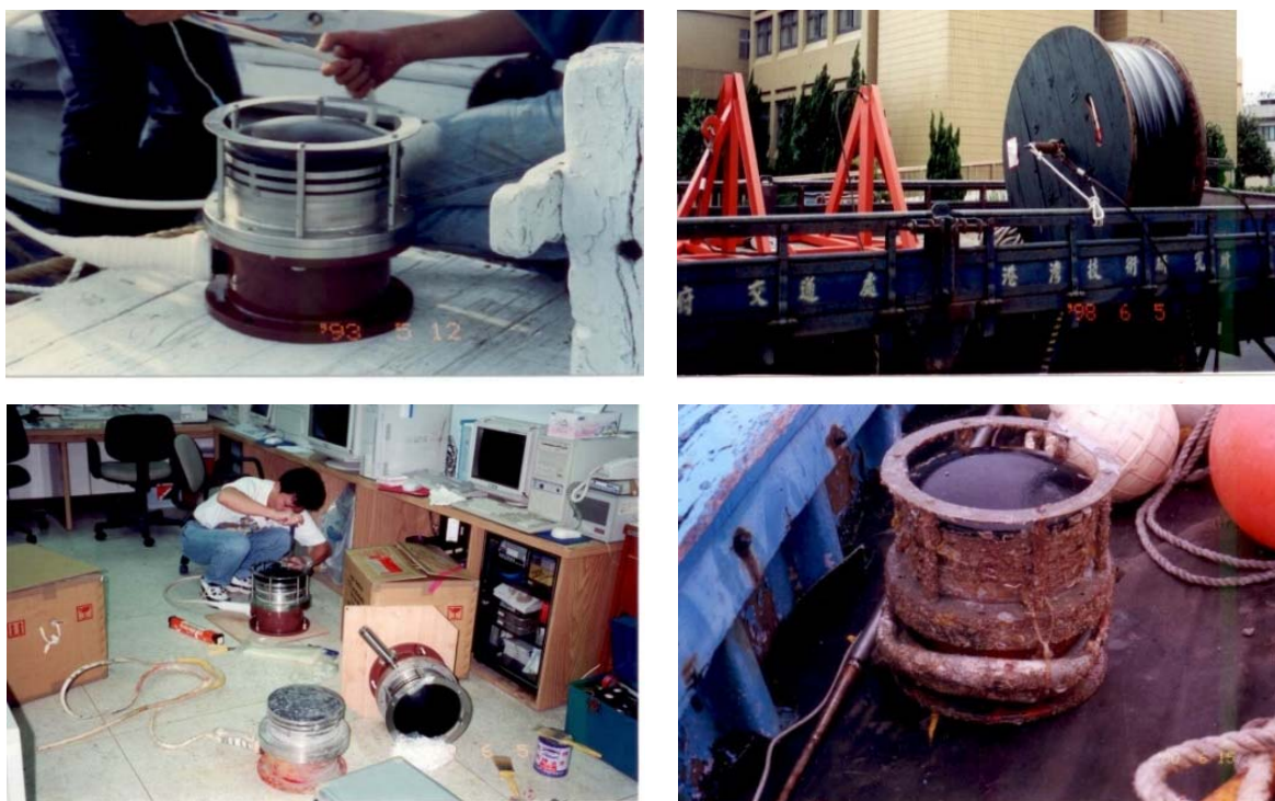
圖 2.1.1 日本 Kaijo 海上電機公司生產之超音波式波高儀
