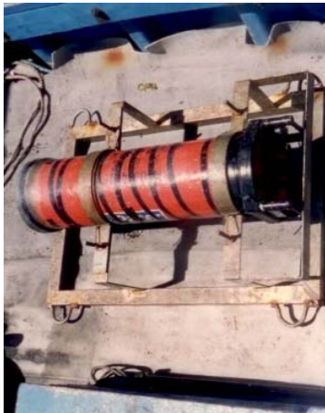
圖 2.1.4 美國 Paroscientific 公司生產之 Facer 壓力式波浪儀及英國 NBA 公司生產之 DNW-5 壓力式波浪儀
