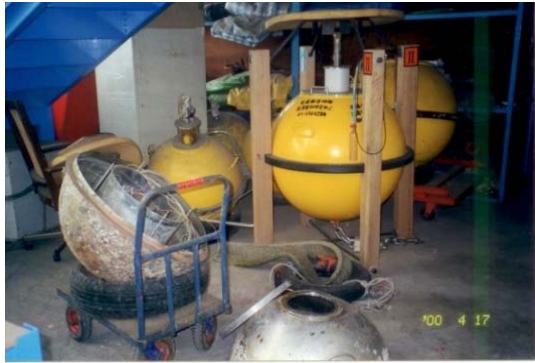
圖 2.1.3 荷蘭 Datawell 公司生產之浮球式波高波向儀
