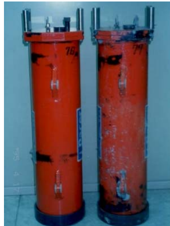
圖 2.1.4 美國 Paroscientific 公司生產之 Facer 壓力式波浪儀及英國 NBA 公司生產之 DNW-5 壓力式波浪儀
