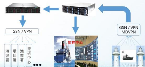
航港局AIS系統網域架構示意圖
