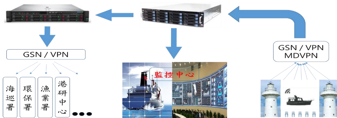
圖 2.3 航港局 AIS 系統網域架構示意圖
