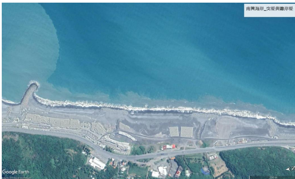
右_大武漁港_南興海岸_離岸堤與圓弧形的突堤配置_細平_20181202. jpg
