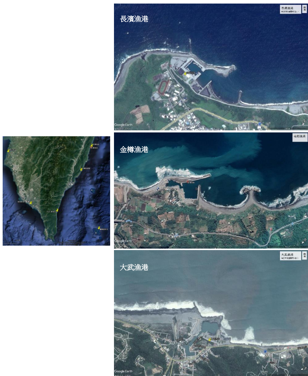
圖 4-39 臺東海岸(左)面對冬、夏季主要波浪入射方向之長濱(右上)、金樽(右中)及大武(右下)漁港既有複合離岸堤及突堤型態之港口配置及與港口毗鄰海岸之防護設施
