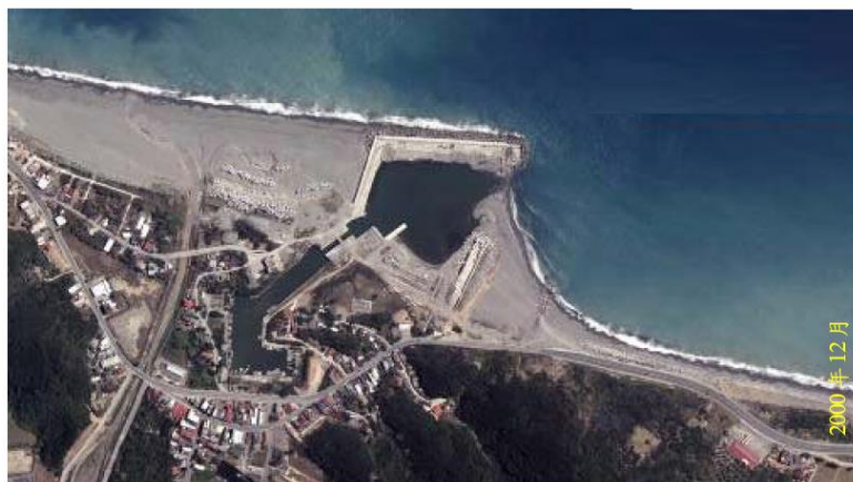
圖 1-7 近岸港口因離岸堤效應造成的港口淤塞與海灘沖蝕
