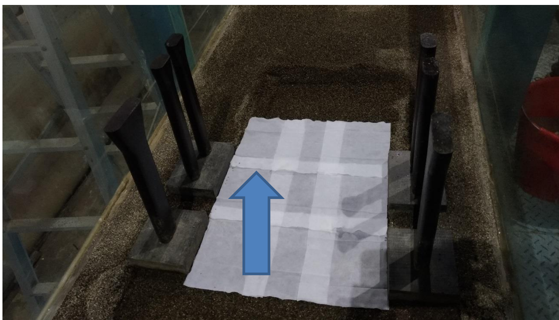
圖 2.26 一層鼎型塊+織布之鋪設
