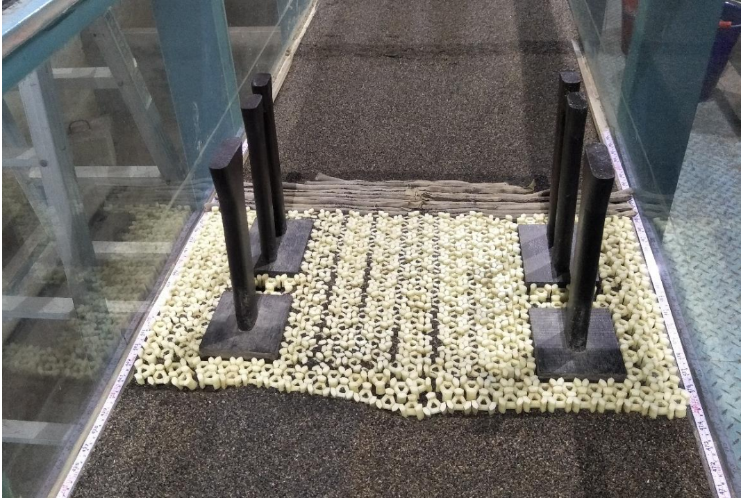
圖 2.31 一層鼎型塊+織布+石籠沖刷情形
