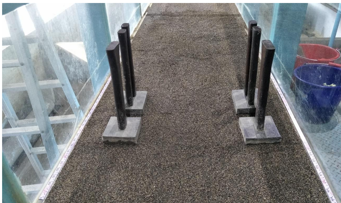
圖 2.22 無保護措施橋墩鋪設
