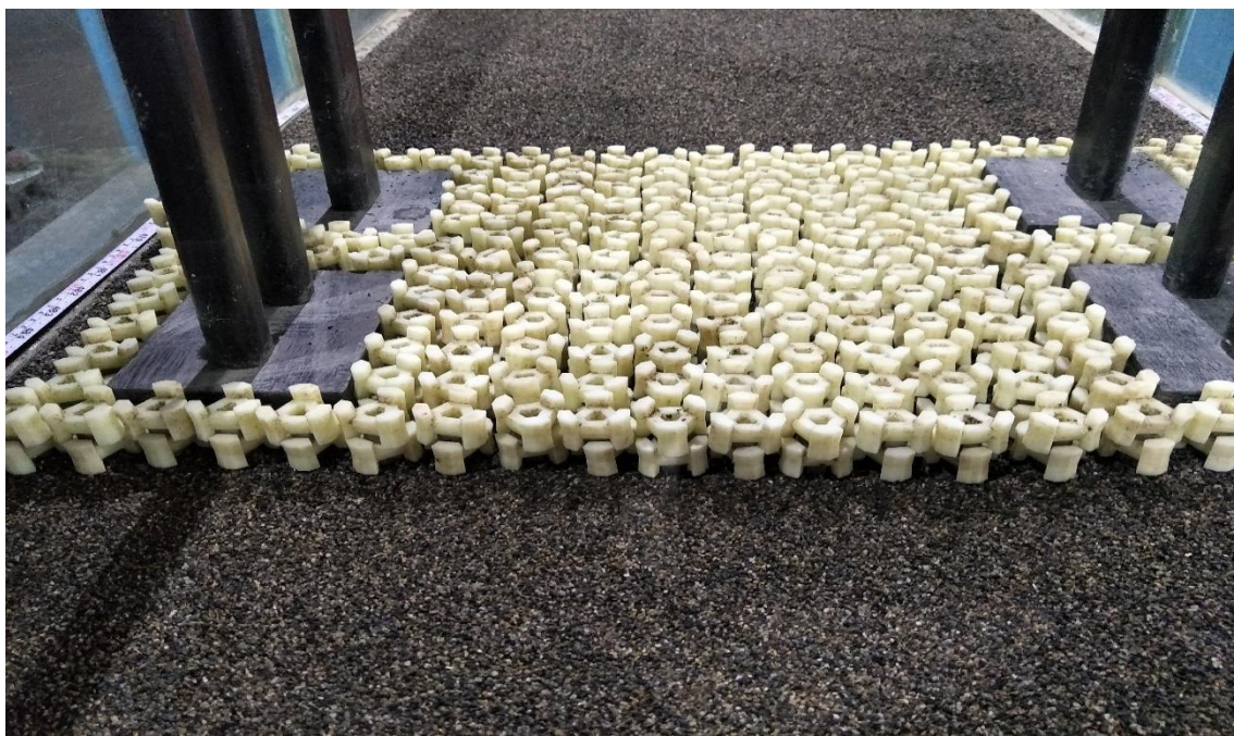
圖 2.20 現況保護措施模型鋪設
