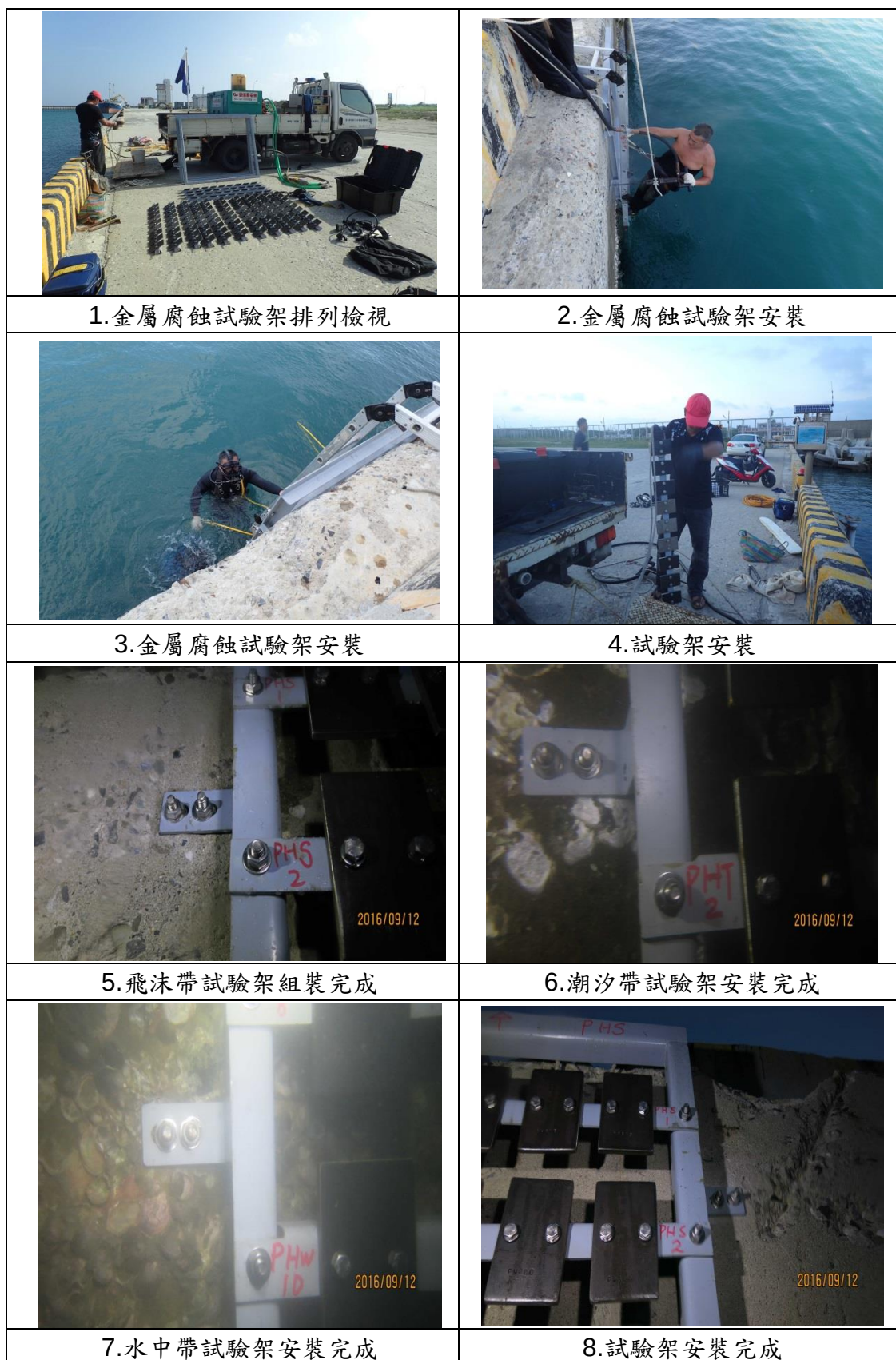
圖 3.15 澎湖龍門尖山港水下金屬暴露試驗架安裝
