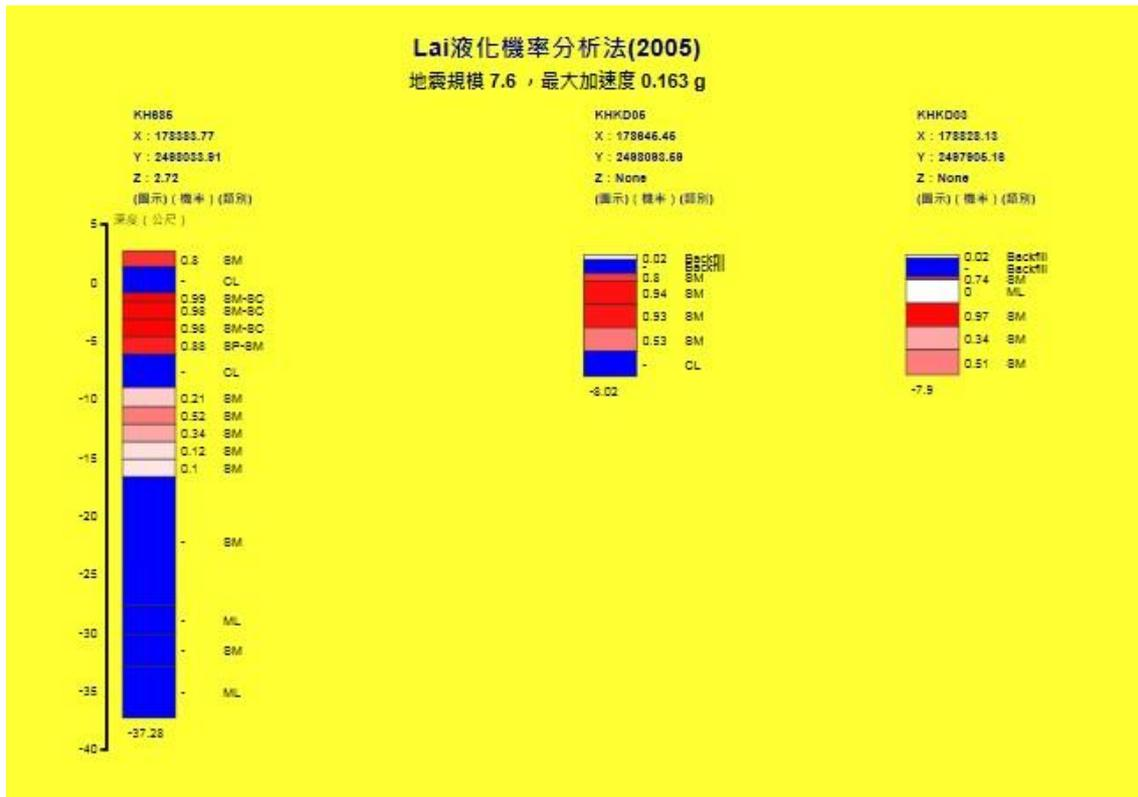
圖 3.40 高雄港鑽探液化柱狀圖 (Lai-由西向東排序)
