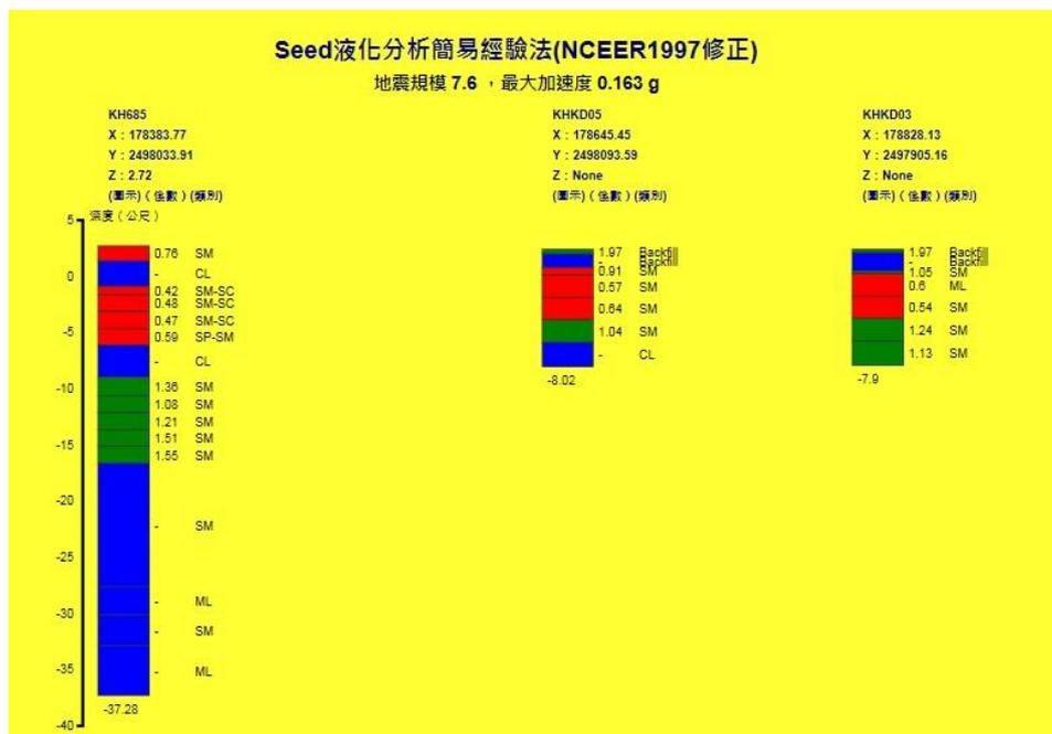
圖 3.26 高雄港鑽探液化柱狀圖 (Seed-由西向東排序)
