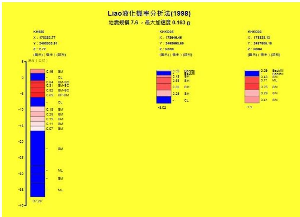
圖 3.39 高雄港鑽探液化柱狀圖 (Liao-由西向東排序)
